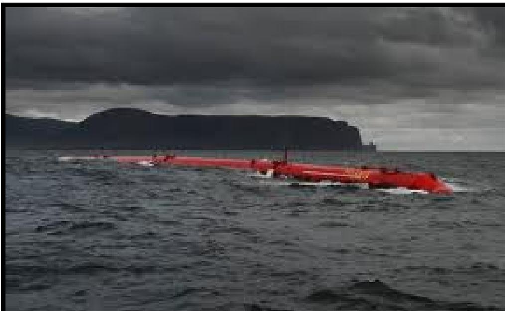
**Emec – Dispositivo Pelamis per onda**
