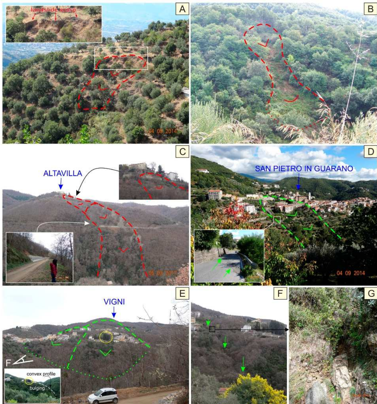
Figura. 2.16 – Tipologie di frane rilevate nell’area di studio: A-C-D) frana per scorrimento in detrito; B) frana complessa; E) frana per scorrimento in roccia; F ) dettaglio del lato della frana coincidente con una fault zone, G, del sistema di faglie NE-SW. In riferimento allo stato di attività A, B,C sono frane attive, mentre E,F frane quiescenti. In riferimento alle categorie di frane: A, B frane superficiali; C,D frane mediamente profonde; E frana profonda.
