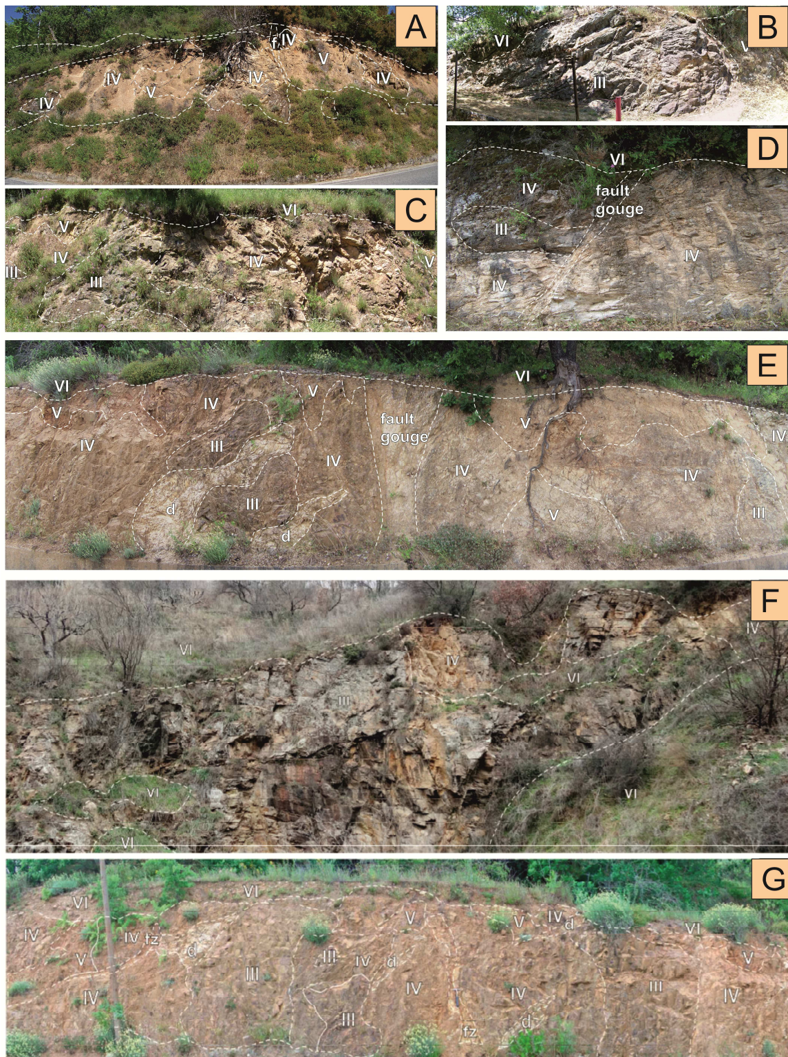
Figura 3.5 – Esempi di profili di alterazione nell’area di studio: (B), (C), (F) profilo tipico nelle porzioni medio basse dei versanti, caratterizzato dalla classe III, con intercalazioni di classe IV, sovrastate da terreno colluviale e depositi detritici (classe VI); (D), (E), (G) profilo di alterazione tipico affiorante lungo le porzioni medio-alte dei versanti, caratterizzato da relazioni geometriche articolate tra le classi III, IV e V (d = filoni aplitici e pegmatitici; fz = zona di faglia); (A) tipico profilo di alterazione che affiorano lungo le porzioni alte dei versanti, caratterizzato principalmente da classe V, con volumi variabili di classe IV (d = filoni aplitici e pegmatitici; fz = zona di faglia).
