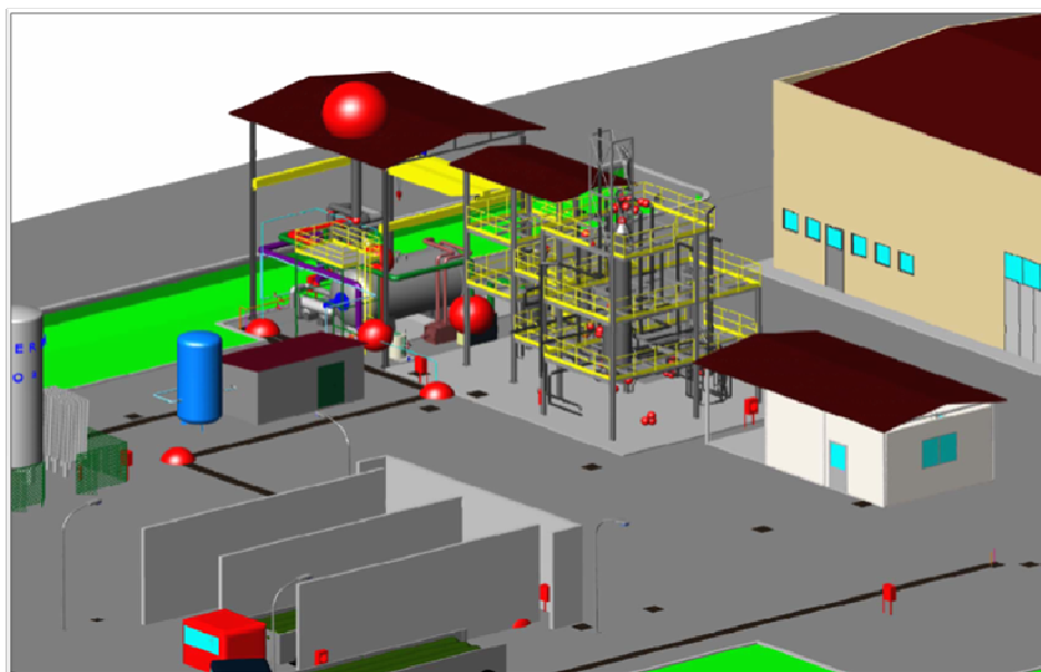
Figura 8.17 Rappresentazione 3D del piazzale con indicazione dei volumi di rischio
