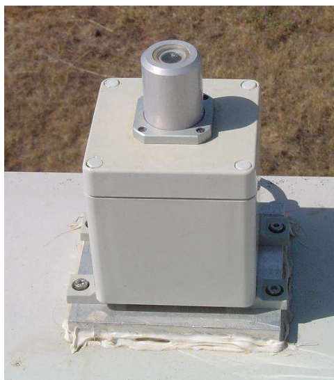
Fig.2.5 - Fotometro per le misura della luminanza zenitale.
