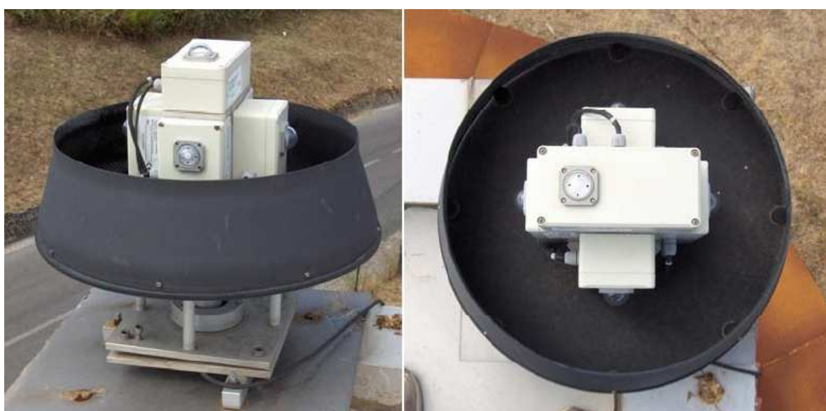
Fig.2.1 - Fotometro per la misura dell'illuminamento globale sul piano orizzontale e su quattro piani verticali.
