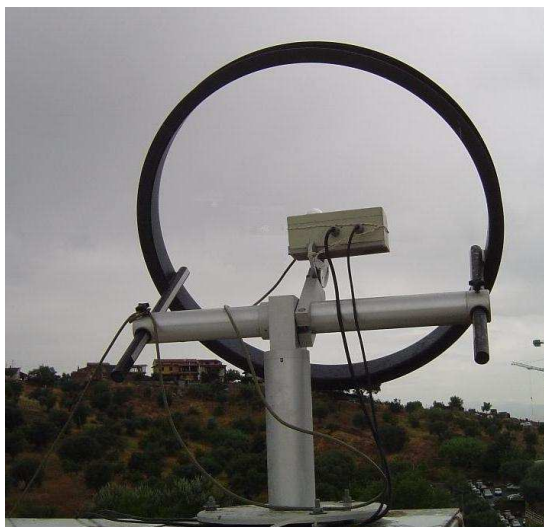
Fig.2.4 - Fotometro con anello di guardia per la misura dell'illuminamento diffuso.
