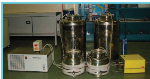
Figura 2.3 - Digestori da laboratorio per la produzione di biogas mediante co-digestione di letame e sansa di olive.
