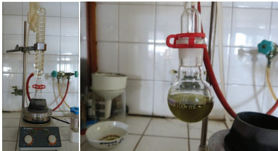
Fig. 3.3 – 3.4 - Sistema di estrazione con solvente mediante percolazione (Laboratorio di Biotecnologie Ambientali e Tecnologie Alimentari, Università degli Studi di Genova).
