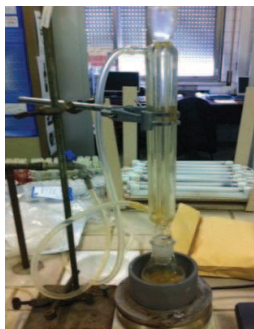
Fig. 3.3 - Estrazione convenzionale mediante percolazione.
