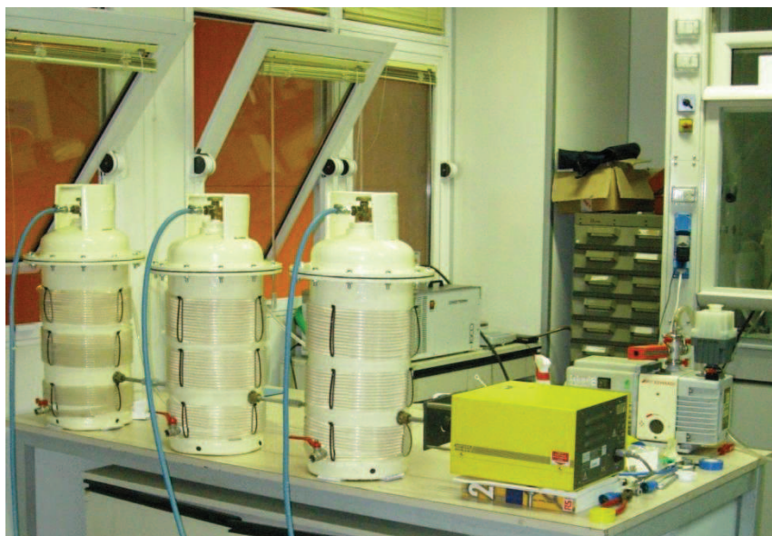
Fig. 2.4 - Sistema di digestori in scala semi-pilota.
