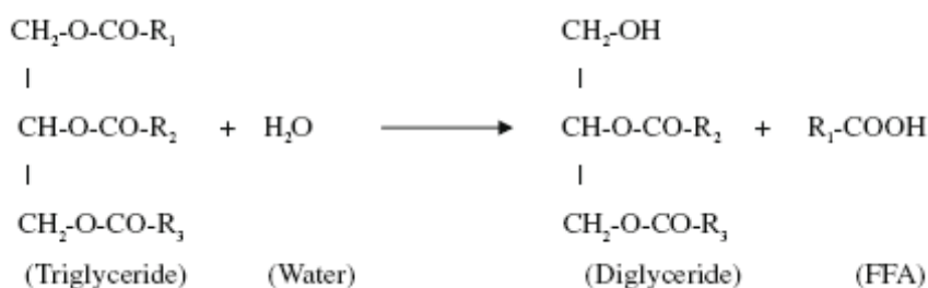
Fig. 1.4 - Reazione indesiderata di idrolisi di un trigliceride durante la transesterificazione basica.
