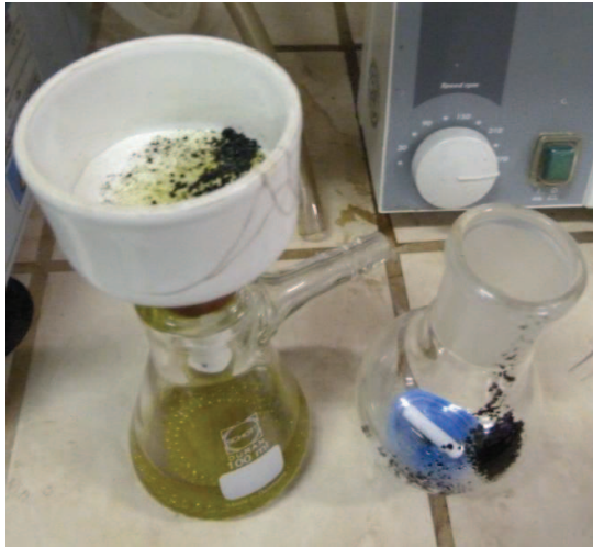
Fig. 3.5 - Separazione della biomassa esausta dopo l'estrazione dal solvente ricco in lipidi (Laboratorio di Biotecnologie Ambientali e Tecnologie Alimentari, Università degli Studi di Genova).
