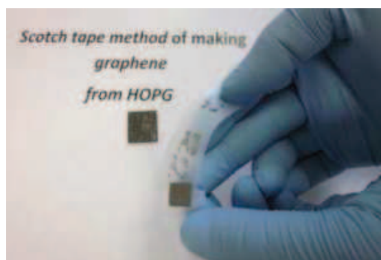
Fig.4: tecnica Scotch-tape (V. Singh et al. Prog. Mater. Sci. , 56 (2011)).
