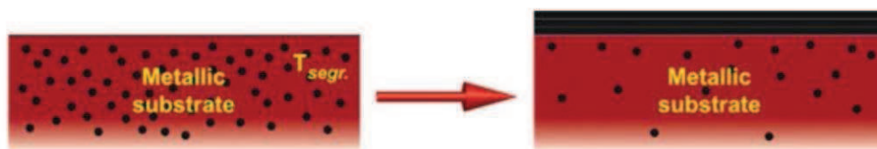
Fig.6: segregazione in superficie degli atomi di carbonio dissolti nel bulk ad alta temperatura T_{segr} (Y. Dedkov et al. "Electron Energy-Loss Spectroscopy in the Electron Microscope" Springer)
