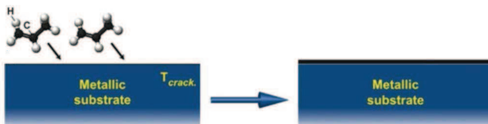
Fig.7: decomposizione (cracking) delle molecole di idrocarburo alla superficie dei metalli di transizione alla temperatura T_{crack} (Y. Dedkov et al. "Electron Energy-Loss Spectroscopy in the Electron Microscope" Springer).
