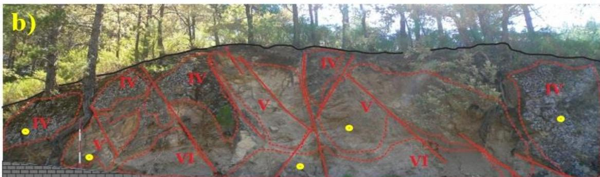
Fig. 2.6- (a) Punti in cui sono stati effettuati i saggi con il martello di Schmidt; (b) Delimitazione definitiva delle zone a diverso grado di alterazione.
