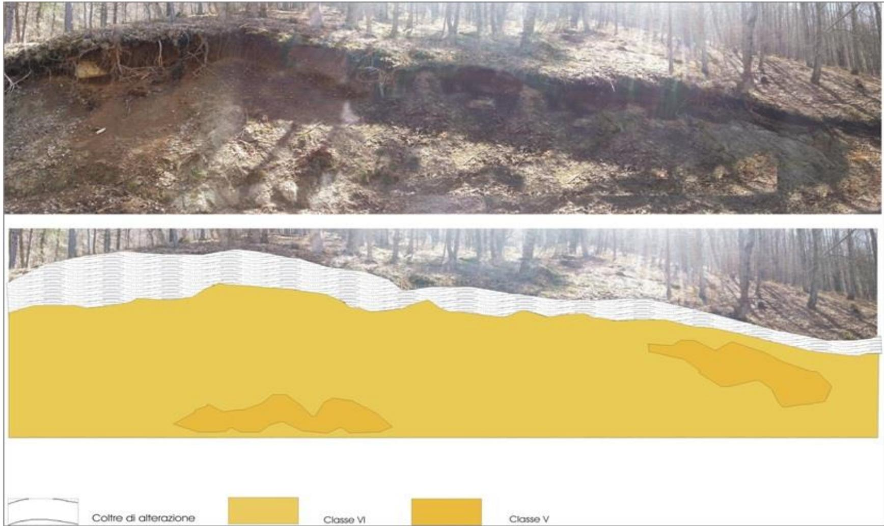
**Fig. 3.26** - Profilo di alterazione tipico di rocce di classe VI: in alto la foto del fronte esaminato; in basso la ricostruzione del profilo di alterazione.
