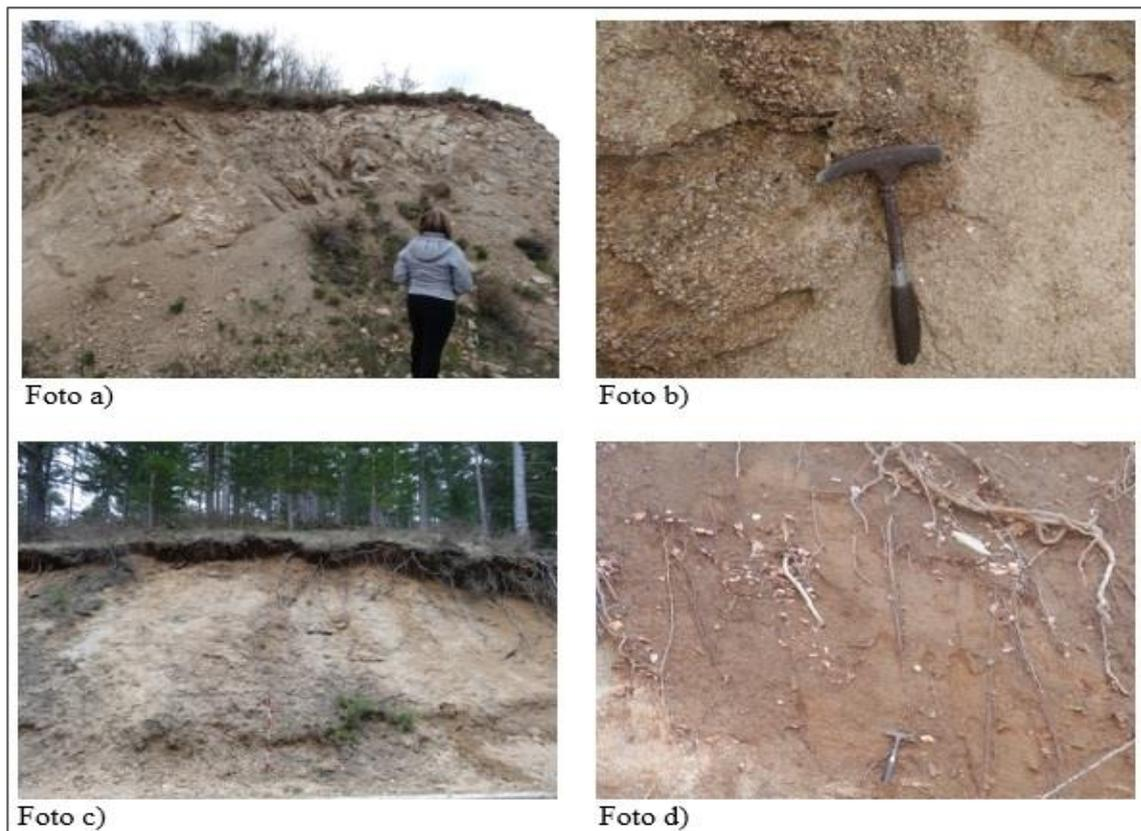
**Fig. 3.19-** Aspetto delle rocce plutoniche rilevate in relazione al grado di alterazione: Foto a) e Foto b) rocce completamente alterate (classe V); Foto c) terreno residuale (classe VI); Foto d) colluvioni (classe VI).
