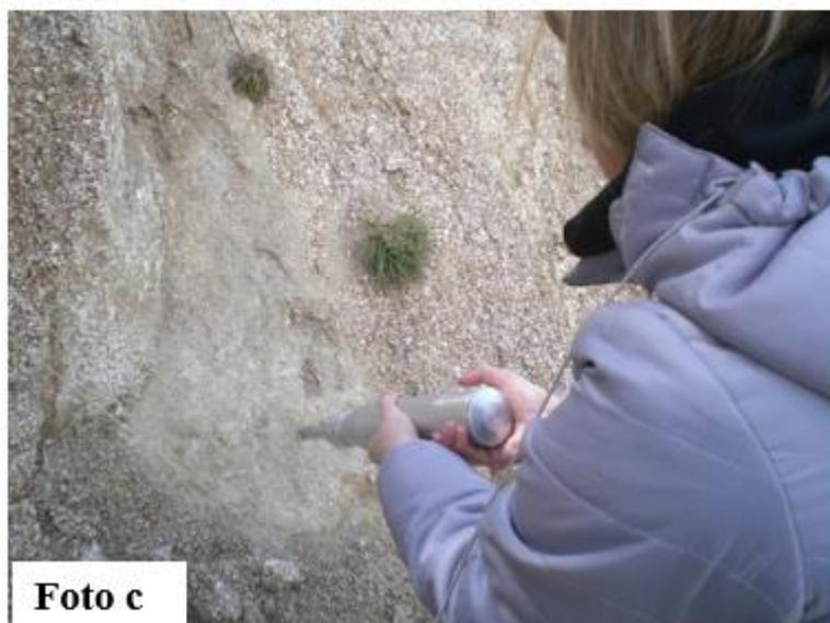
Fig. 2.7- (a) verifiche puntuali sul fronte con la bussola; (b) con il martello da geologo; (c) con il martello di Schmidt.
