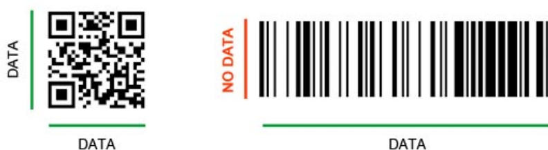
Figura 11: Esempi di codice a barre lineare e bidimensionale
