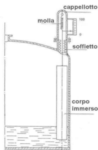
Figura 36: misuratore a spinta idrostatica con sospensione a molla cilindrica
