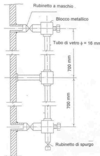
Figura 31: misuratore di livello a tubo di vetro
