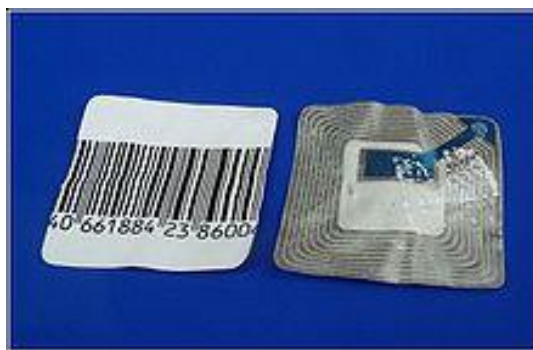
Figura 14: Esempio di RFID aperto
