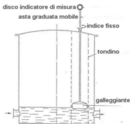
Figura 35: misuratore di livello a galleggiante con indicazione ad asta graduata
