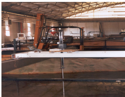
Fig. 4.8 Asta idrometrica per le misure dei livelli idrici nella vasca
