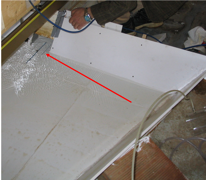
Fig. 4.9 Presa piezometrica nella vasca. Vista dall'alto
