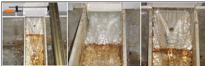
Fig. 4.15 – Formazione dei due fronti d'onda simmetrici immediatamente a valle della paratoia generati dalla contrazione laterale della vena liquida nel passaggio sotto la paratoia
