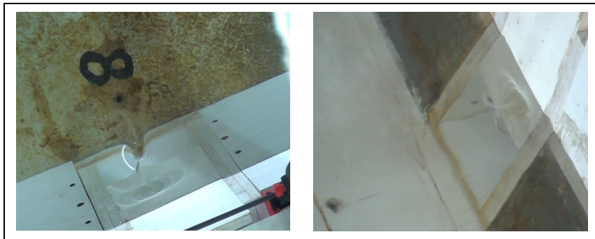
Fig. 4.14 – Configurazione di “vortice completamente sviluppato” immediatamente a monte della paratoia
