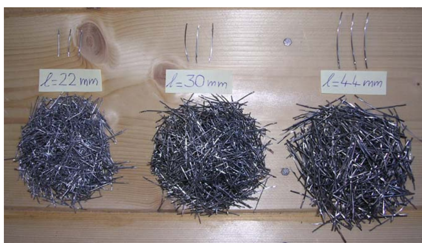
Fig. 3.1. Prima serie di prove: fibre metalliche utilizzate.
