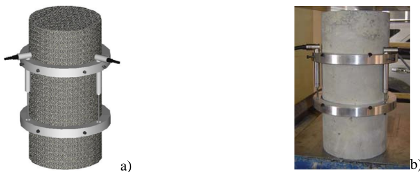
Fig. 3.5. Set-up di prova: a) Schema geometrico; b) attrezzatura sperimentale.
