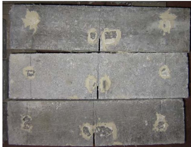
Fig. 4.17. Provini prismatici dopo la prova in calcestruzzo rinforzato con fibre in polipropilene ( V_f=2\% ).
