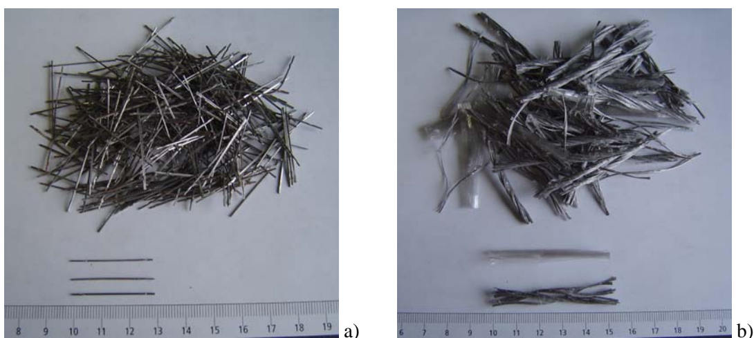
Fig. 3.2. Seconda serie di prove: a) fibre metalliche; b) fibre in polipropilene.
