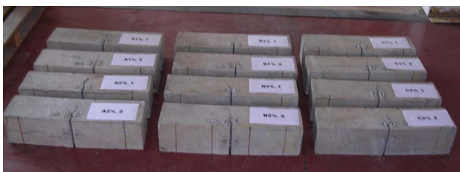
Fig. 4.2. Provini prismatici di calcestruzzo fibrorinforzato dopo la prova.
