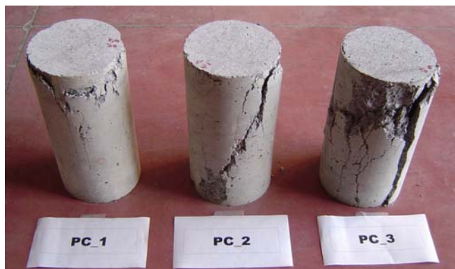
Fig. 4.5. Provini cilindrici di calcestruzzo di base dopo la prova.
