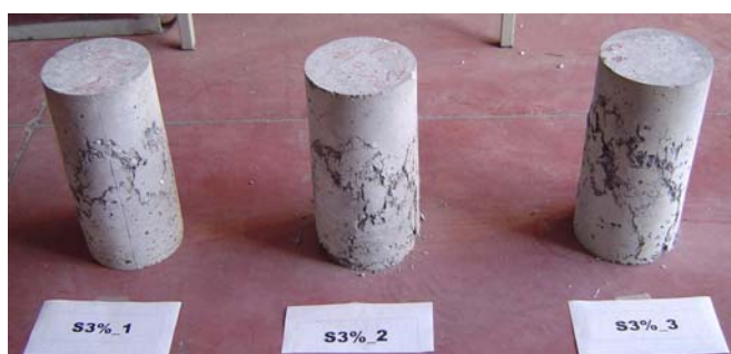
Fig. 4.6. Provini cilindrici di calcestruzzo con il 3% in volume di fibre d'acciaio dopo la prova.
