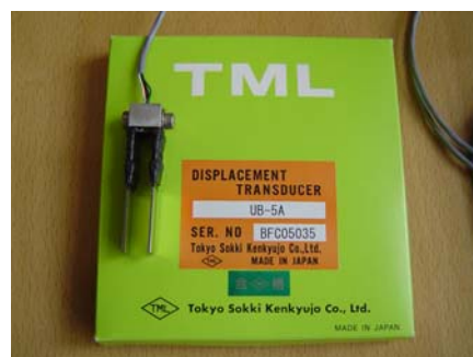
Fig. 3.9. Trasduttore resistivo a ponte intero TML.
