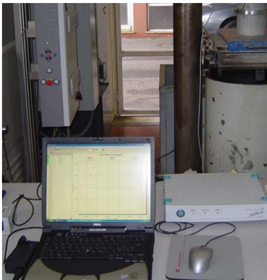
Fig. 3.6. Prova di compressione: apparato sperimentale.
