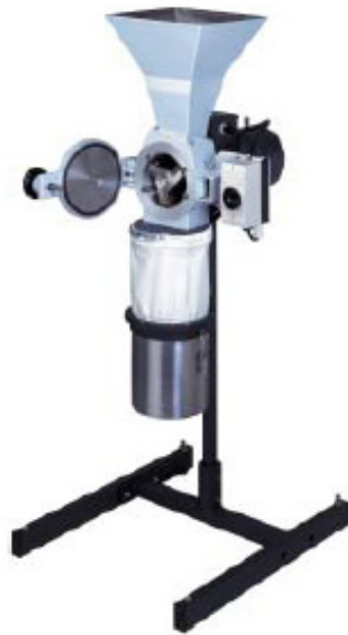
Figura 3.16 – Mulino a coltelli mod. Retsch SM-100
