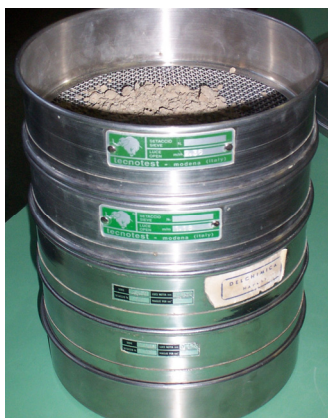
Figura 4.3 - Stacciatura di un campione di argilla
