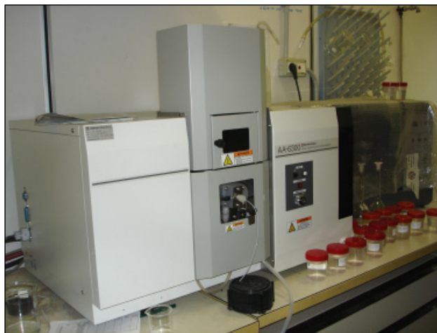
Figura 3.10 – Spettrofotometro di assorbimento atomico SHIMADZU modello AA6300
