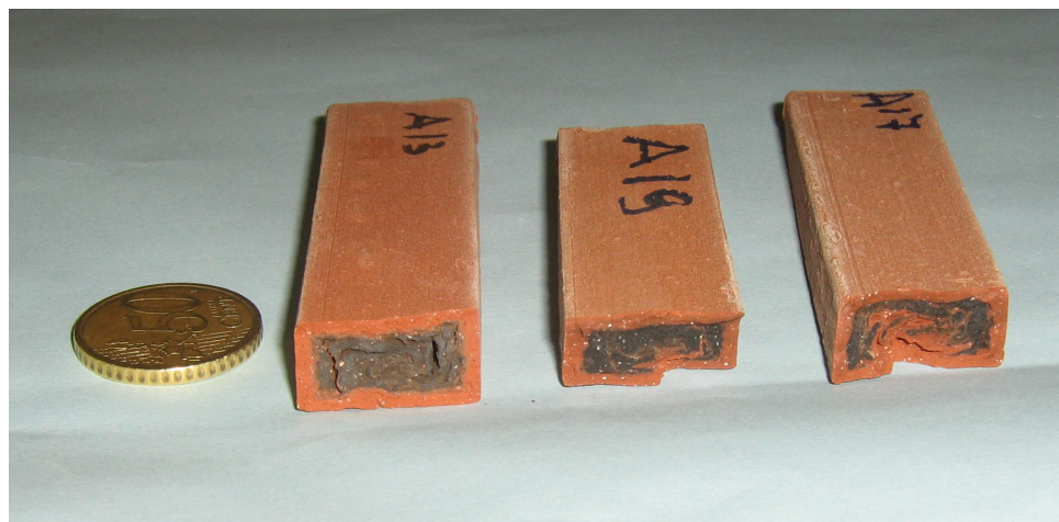
Figura 5.2 – Campioni cotti a 1000 °C (a sx) e 1050°C (a dx), tempo di cottura 1h
