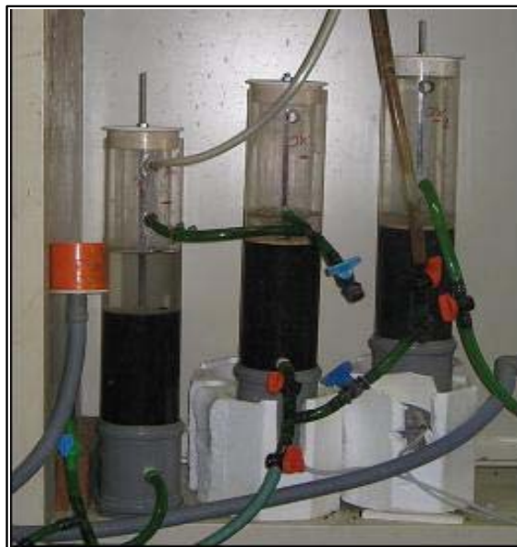
Figura 6.1: Impianto pilota del tipo a biofiltri sommersi in scala di laboratorio
