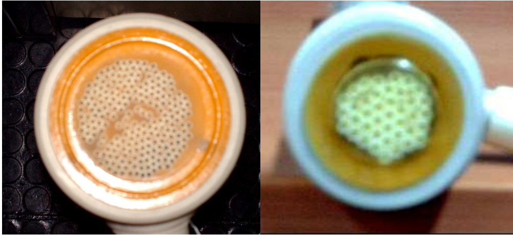
Fig. 18. Sezioni di moduli Microdyn Technologies, Enka (Germany) di differenti aree; a) area maggiore, b) area minore.
