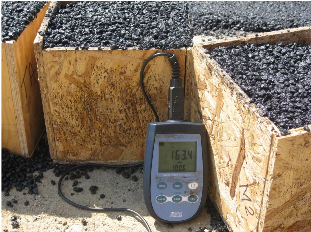
Fig.7.9 (o)- Prelievo del materiale e verifica delle temperature
