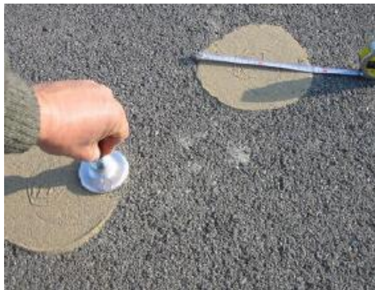
Fig. 3.34 – Metodo dell’altezza in sabbia
