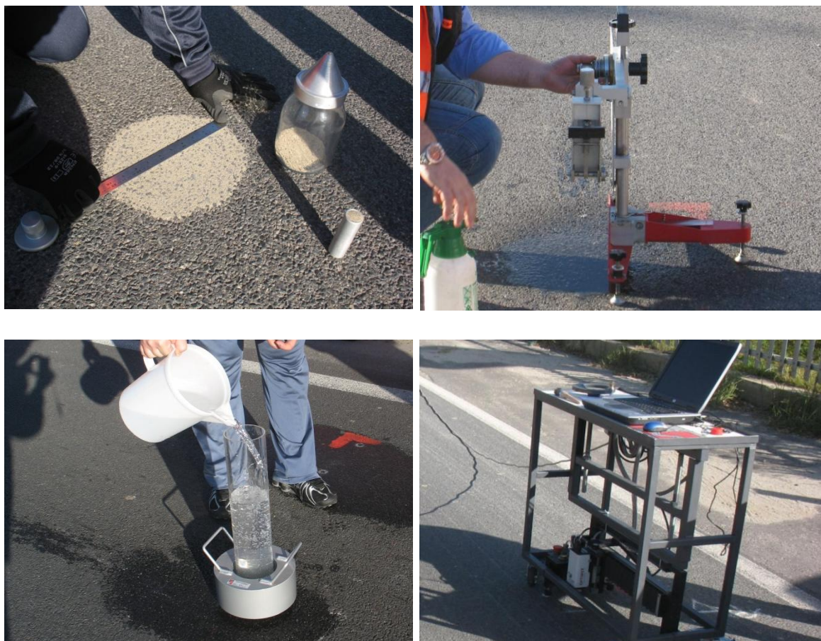
Fig.7.18 - Rilievo delle caratteristiche superficiali con le 4 strumentazioni utilizzate
