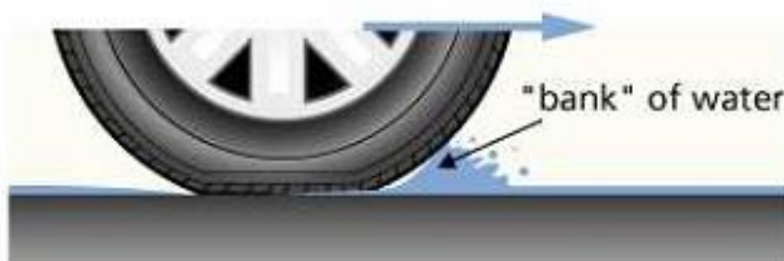
Fig. 2.17 - Formazione del cono d'acqua sull'area di contatto.
