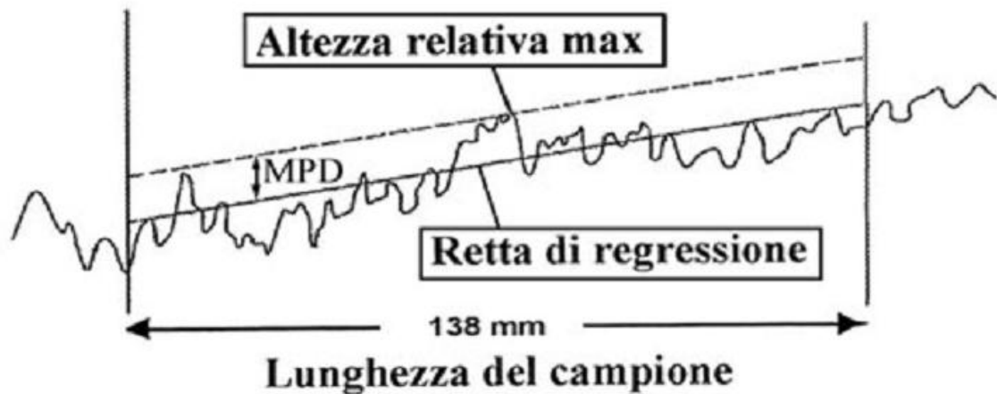
Fig. 3.5 – Definizione AIPCR della profondità media di profilo [03]
