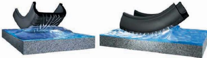
Fig. 2.19 - Schematizzazione del fenomeno dell'aquaplaning
