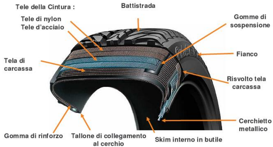
Fig. 2.33 - Nomenclatura delle parti principali di un pneumatico [61]
