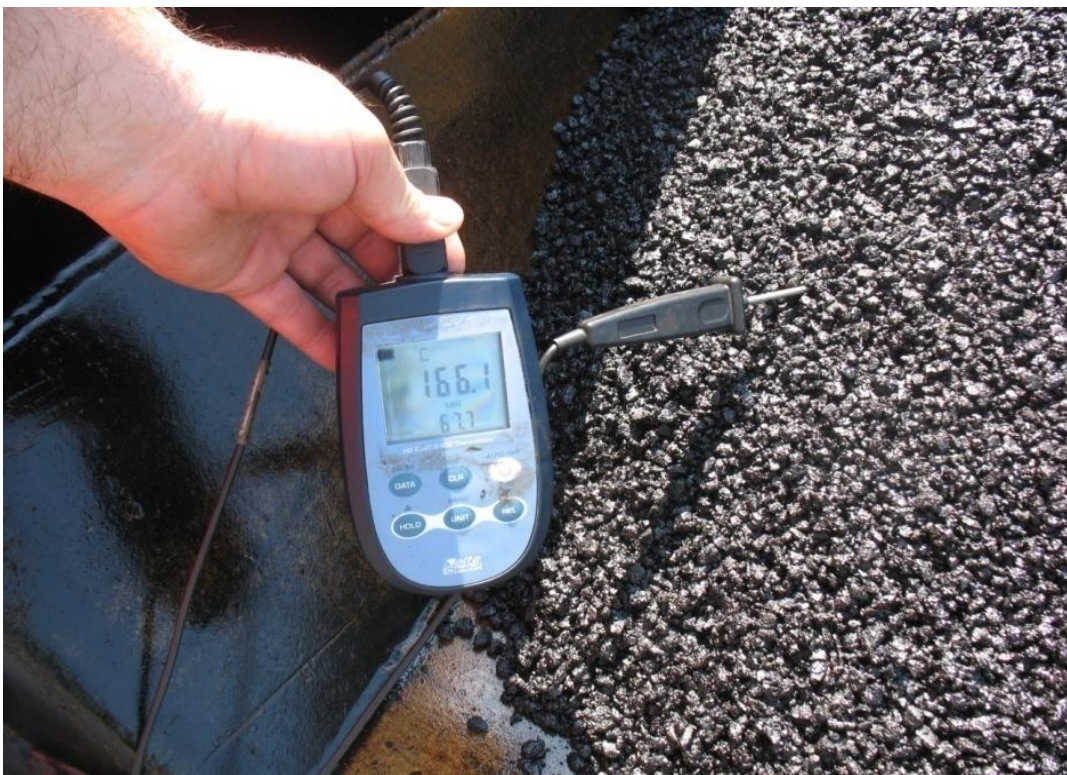
Fig.7.9 (p)- Prelievo del materiale e verifica delle temperature
