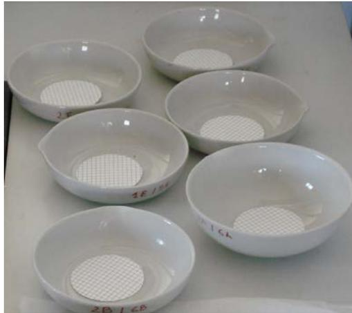
Figura 4.2: Filtri con aperture nominali dei pori di 0.45 µm.
