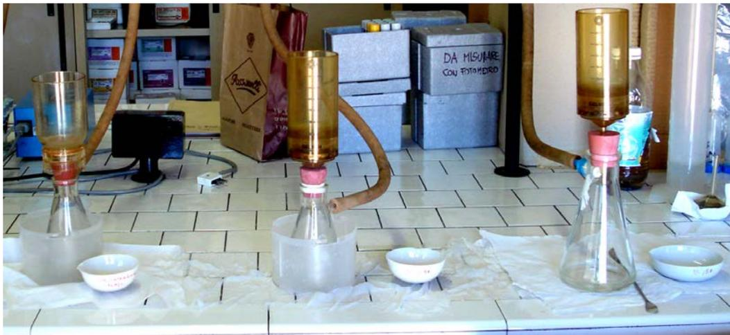
Figura 4.5: Apparecchi utilizzati per la determinazione dei TSS.
