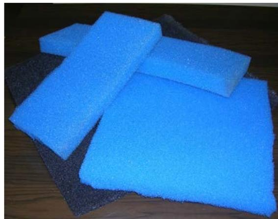
Figura 4.30: Spugna del tipo Filtren TM 24450 prodotto da Åkesson (<http://www.b-akesson.se>).
