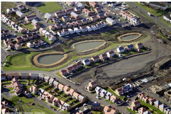
Figura 2.33: Sistema di tre stagni presso Kirkcaldy in Scozia, Regno Unito (<http://sudsnet.abertay.ac.uk>).
