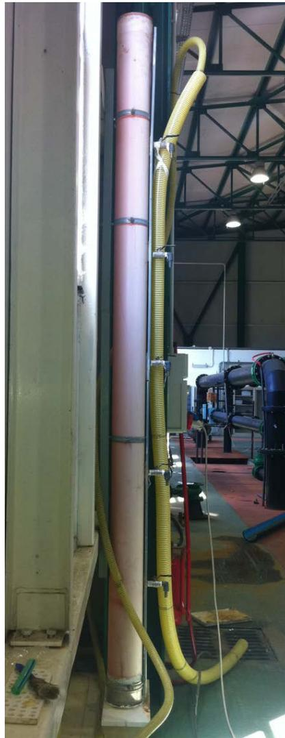
**Figura 4.1: Colonna di sedimentazione presso il Laboratorio di Grandi Modelli Idraulici (Università della Calabria).**
