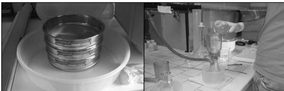
**Fig. 3** - *Setacci metallici e filtri a membrana*
