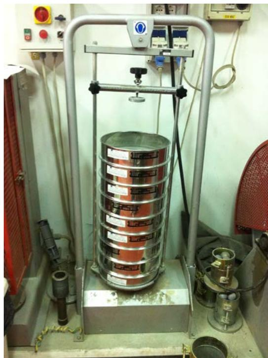
Figura 4.32: Determinazione della PSD della miscela quarzite e zelbrite mediante setacciatura.
