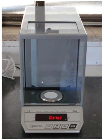
Figura 4.4: Bilancia di precisione per la pesatura dei filtri.
