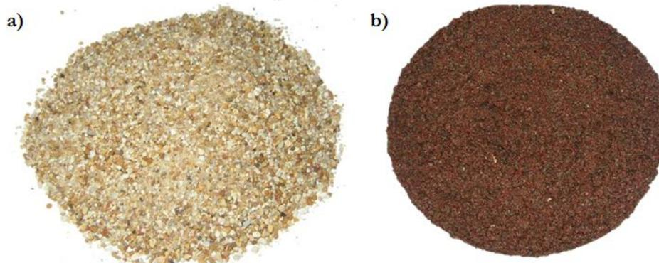
Figura 4.31: a) Sabbia di quarzite; b) zelbrite (prodotta da Zeolite Australia P/L).
