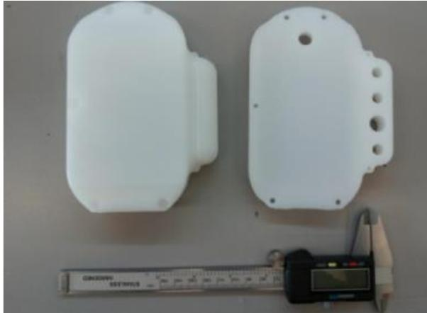
**Figura 3.44 - Case elettronica fresato**
