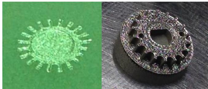
**Figura 2.24 - Puleggia dentata (2 fig 2.8) durante e dopo la sinterizzazione**
