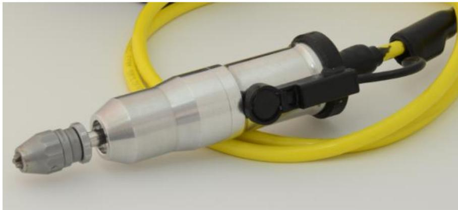
**Figura 4.12 - Micro-fresa assemblata e cavo stagno**
