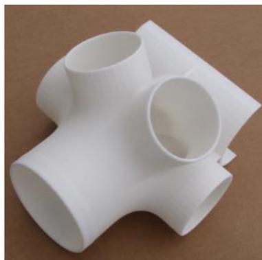
**Figura 1.17 - Componente stampato con tecnologia SLS**
