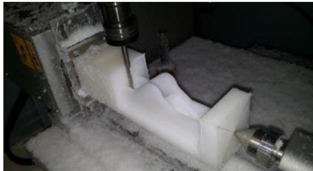
**Figura 3.37 - Realizzazione componenti per fresatura a controllo numerico**
