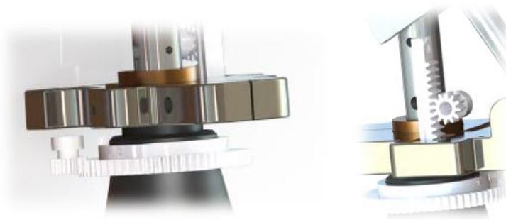
**Figura 3.18 - Sistema ingranaggi encoder pan tilt**
