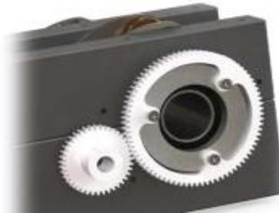
**Figura 3.13 - Ingranaggio encoder sul link-0**
