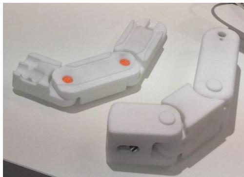
**Figura 2.20 - Dito robotico sinterizzato e la sua sezione**
