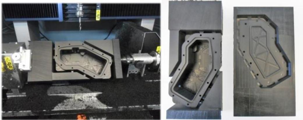
**Figura 4.28 - Realizzazione CNC del case principale**
