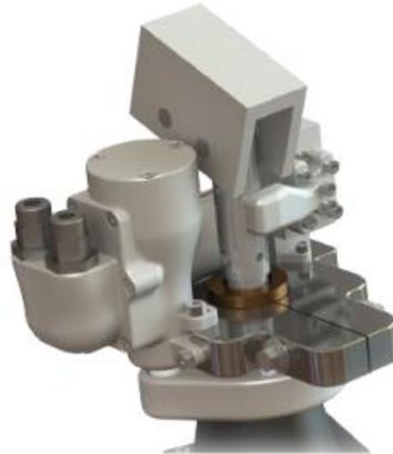
**Figura 3.20 - Modello CAD del sistema Pan tilt**
