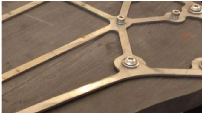
**Figura 3.36 - Piastra del link 1 e struttura di supporto**
