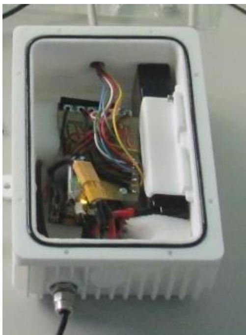
**Figura 2.30 - Pacco batteria ed elettronica**
