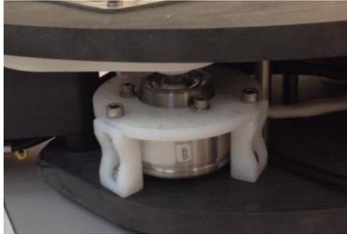
**Figura 3.39 - Encoder e struttura di fissaggio in posizione**
