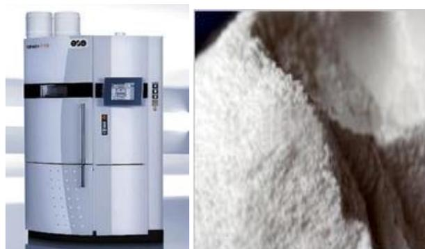
**Figura 2.18 - Eos Formiga P110 e polvere di PA2200**
