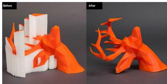
**Figura 1.15 - Componente stampato con tecnologia FDM**
