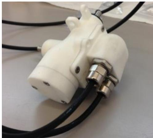
**Figura 3.40 - Case stagno per encoder end-effector**
