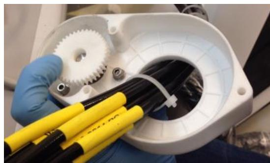
**Figura 3.38 - Particolare dei ingranaggio e cover protettivo degli encoder**
