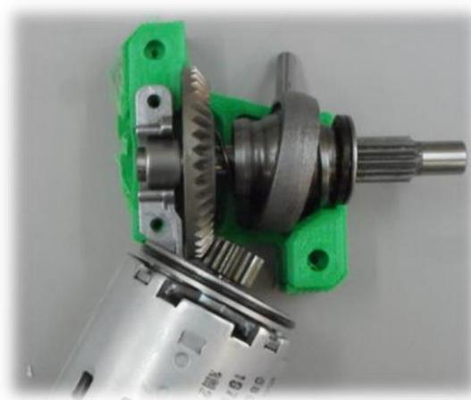
**Figura 4.27 - Sistema di trasmissione del moto**
