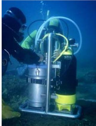
**Figura 1.14 - Iniettore di malta a pressione**
