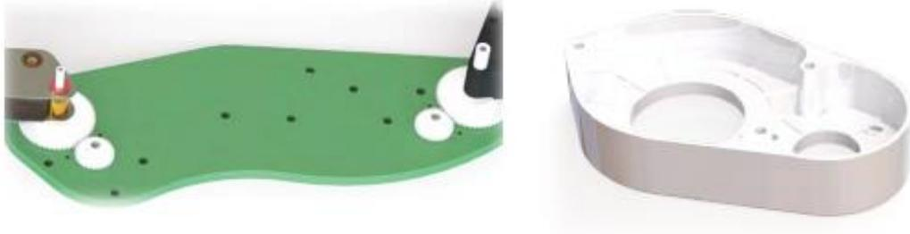
**Figura 3.14 - piastre con ingranaggi per 2° e 3° encoder e carter protettivo**
