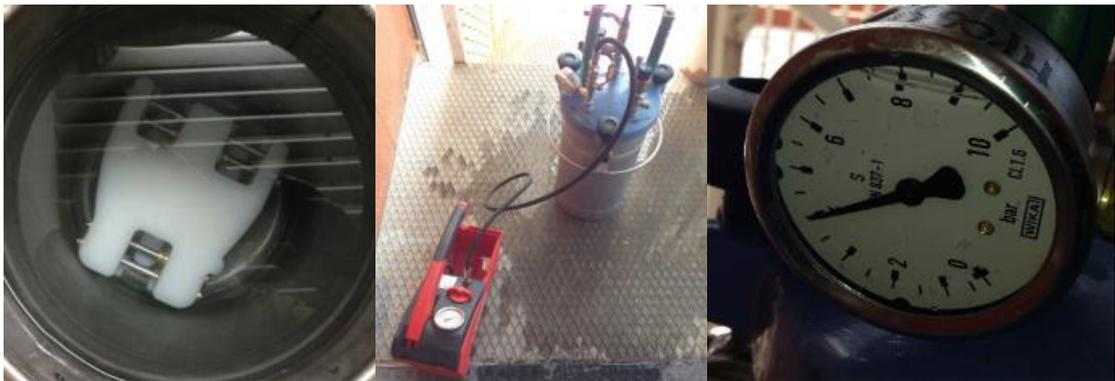
**Figura 2.31 - Test in camera idrostatica**
