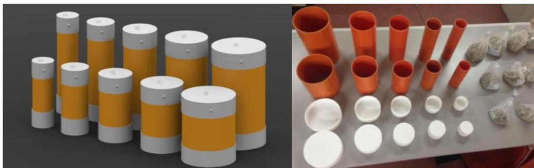
**Figura 2.36 - Cilindri di prova e pesi noti, modello CAD e componenti reali**
