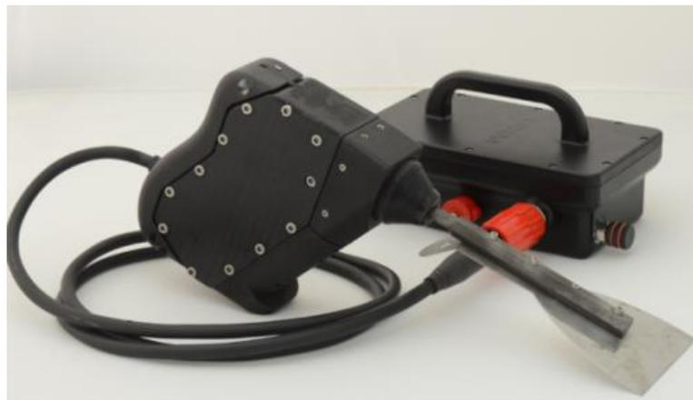
**Figura 4.31 - Percussore assemblato con spatola inox**
