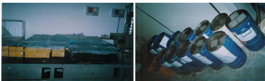
Figura 7.2 - Stagionatura dei provini prima e dopo la sformatura
