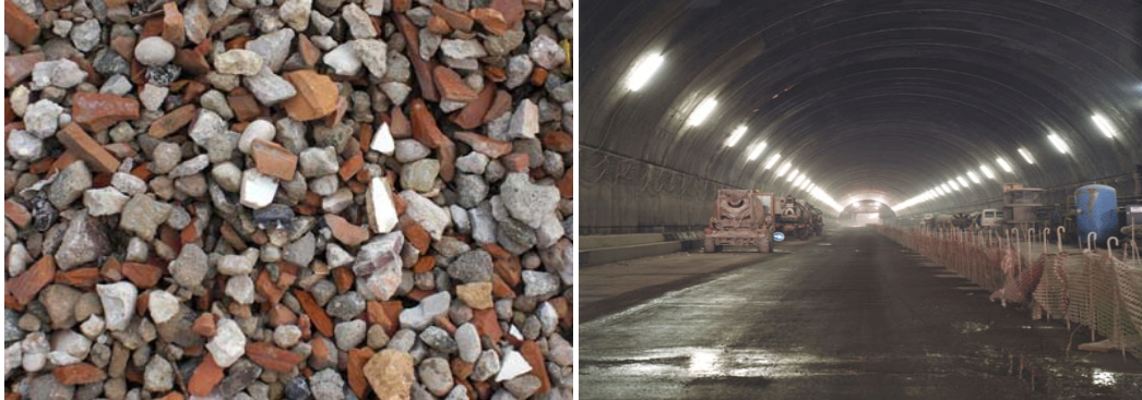
Figura 3.11- Aggregato riciclato e applicazione come misto granulometrico per sottofondo stradale
