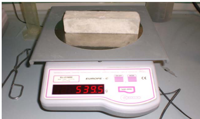
Figura 4.13 – bilancia di precisione utilizzata per la rilevazione del peso dei provini
