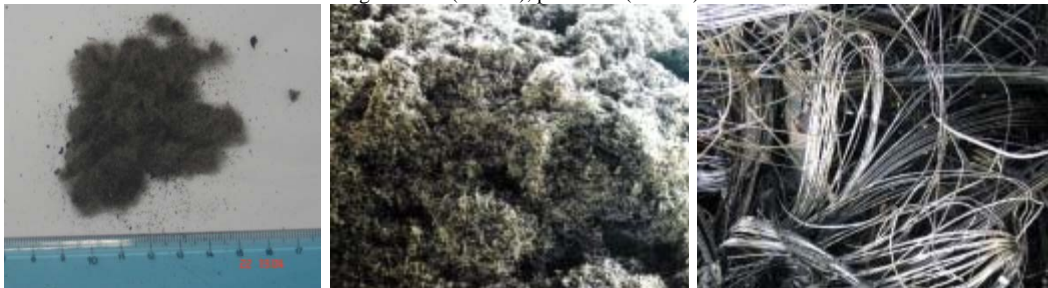
Figura 1.20 – Tessili e fibra metallica ottenibile dal processo di triturazione meccanica
