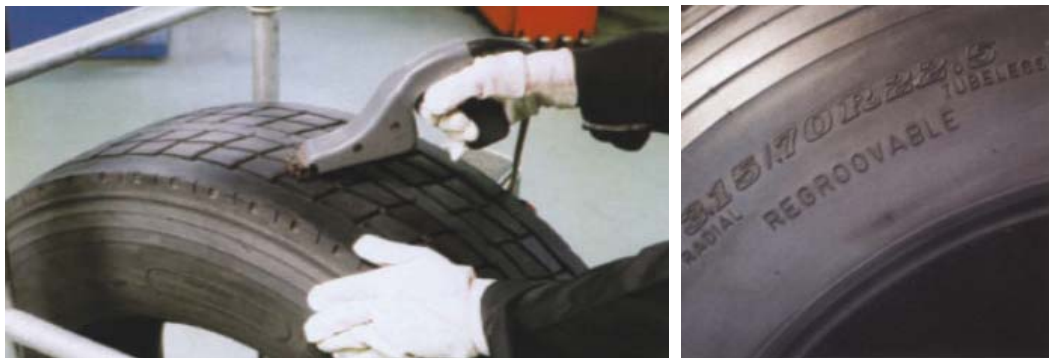
Figura 1.14 – Processo di riscolpitura e dicitura riportata sul pneumatico
