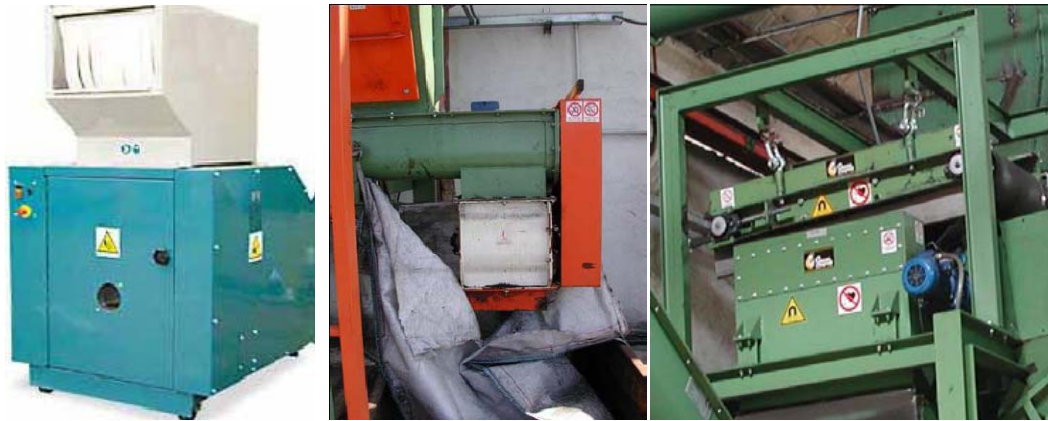
Figura 1.18 – Esempi di granulatore secondario, aspiratore e separatore magnetico
