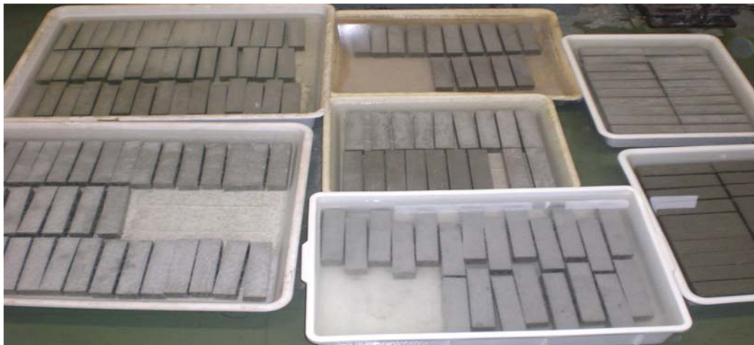
Figura 6.46 - Stagionatura di alcuni provini di terza serie
