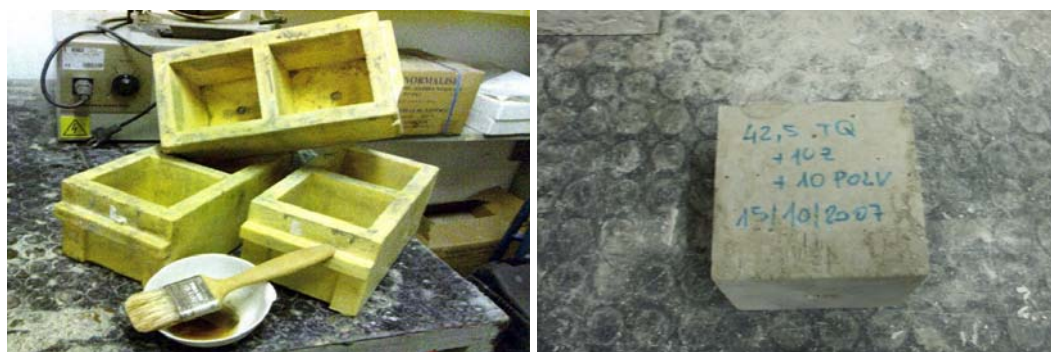
Figura 7.1 - Casseforme usate per il confezionamento dei provini e provini siglati per l'identificazione
