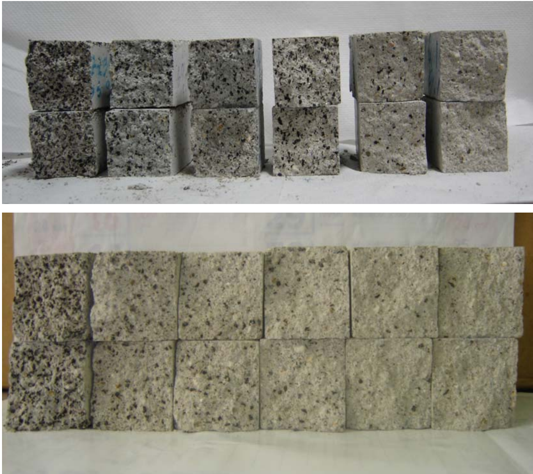
Figura 6.25 – Serie di provini con differenti percentuali di gomma PFU
