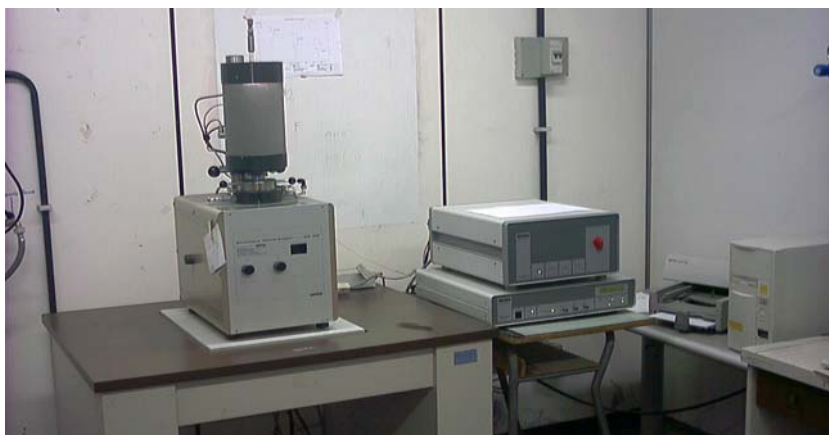
Figura 4.5 - Analizzatore termico Netzsch STA 409
