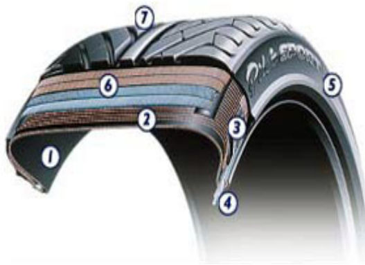
Figura 1.5 Struttura tipica di un pneumatico da autovettura
