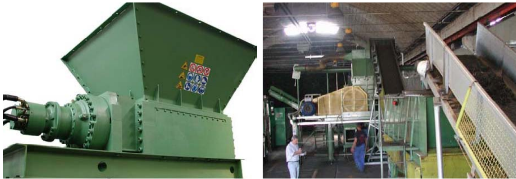
Figura 1.16 – Esempi di trituratore meccanico e nastri trasportatori
