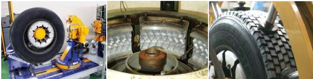
Figura 1.15 – Fasi della ricostruzione di un pneumatico
