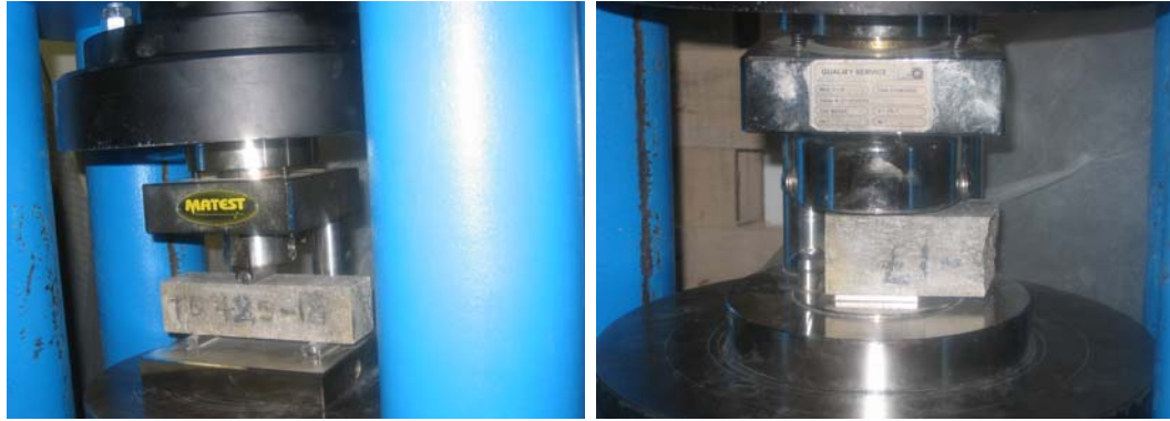
Figura 6.64 – Dispositivi usati per l'esecuzione della prova a flessione e della prova a compressione
