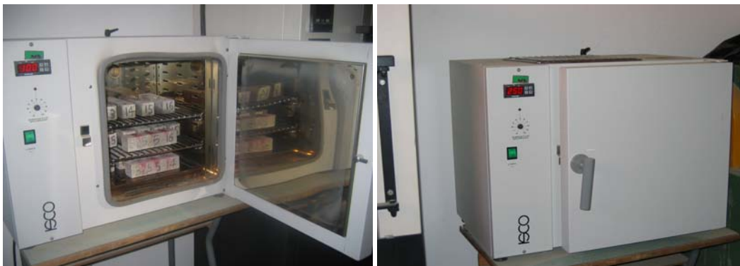
Figura 4.14 – Fasi delle prove di trattamento termico dei provini di malta cementizia
