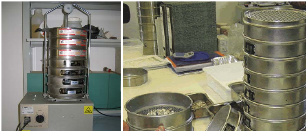
Figura 4.12 – Dispositivo elettrico e setacci utilizzati per eseguire le analisi granulometriche
