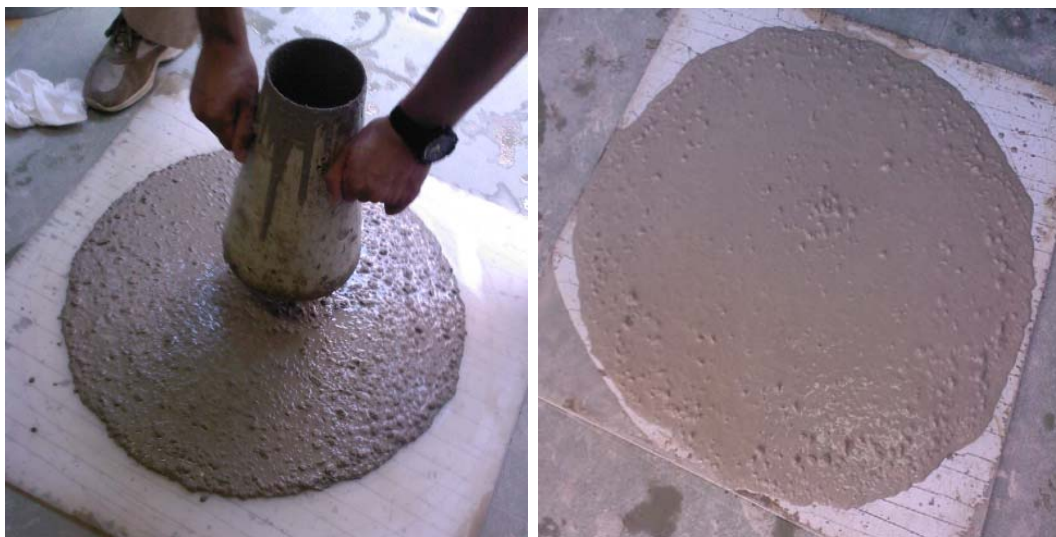
Figura 7.21 - Spandimento ottenuto dalla prova dello slump flow per l'impasto della miscela ZC
