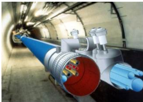
Figura 4.2 Sistemazione dell'anello nei tunnel del CERN
