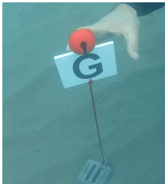
Figura 5.4 – Uno dei 4 marker posizionati sul fondale, con relativo galleggiante.
