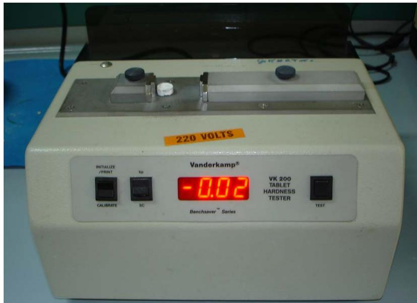
Figura 5.10 – Vanderkamp hardness tester
