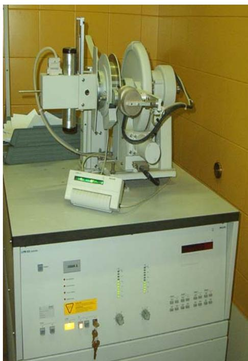
**Figura 5.3 - Diffratometro Philips modello PW**
