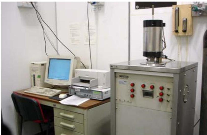
**Figura 4.5** - *Strumento per analisi termiche*
