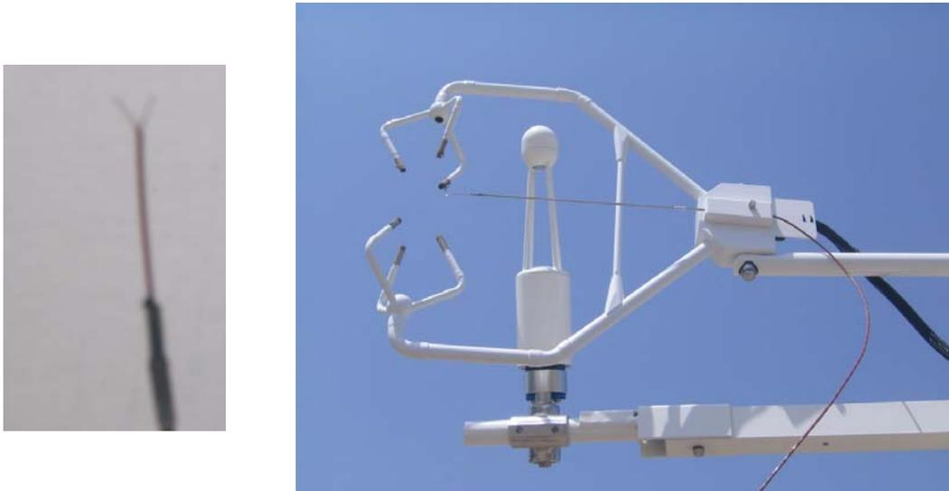
Figura 6.6. La termocoppia a filo sottile FW05 in primo piano ed installata insieme all'analizzatore di gas e all'anemometro sonico.
