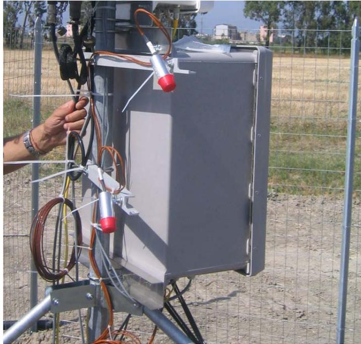
Figura 6.7. I due termometri ad infrarosso IRTS-P appena installati.
