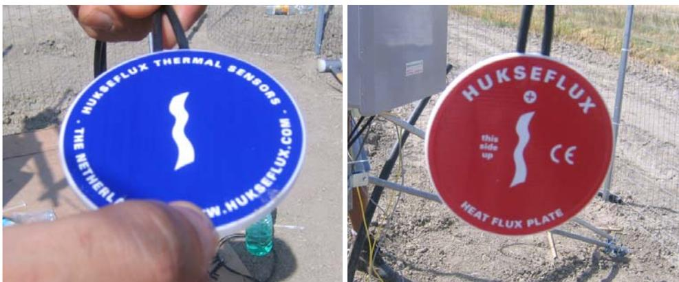
Figura 6.8. La piastra di flusso termico autocalibrante HFP01SC (vista fronte e retro).
