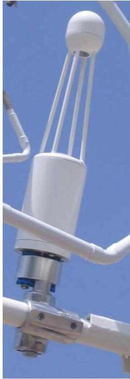
Figura 6.4. L'analizzatore di gas a cella aperta LI-7500.
