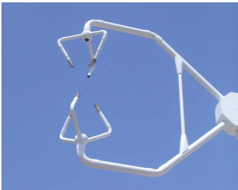
Figura 6.5. L'anemometro ad ultrasuoni CSAT-3.
