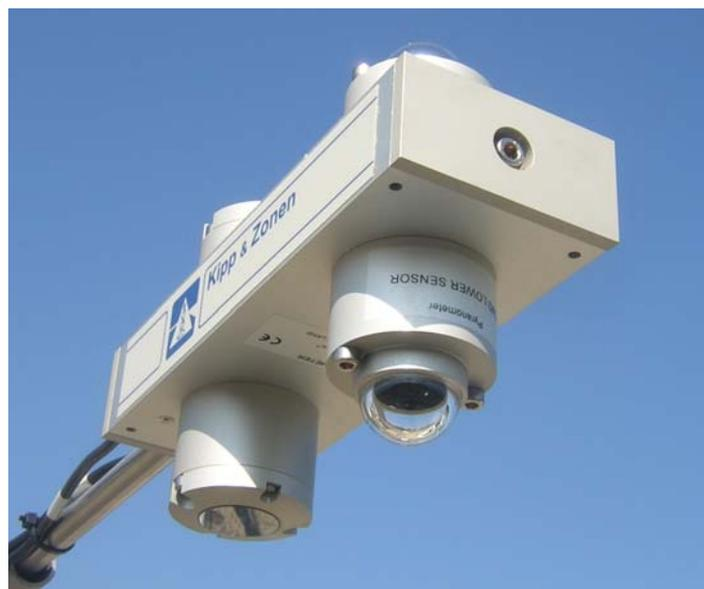
Figura 6.9. Il radiometro netto CNR1.
