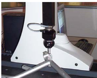
Fig 5.20 - Processo di acquisizione punti appartenenti alla sezione trasversale di un elemento cilindrico.
