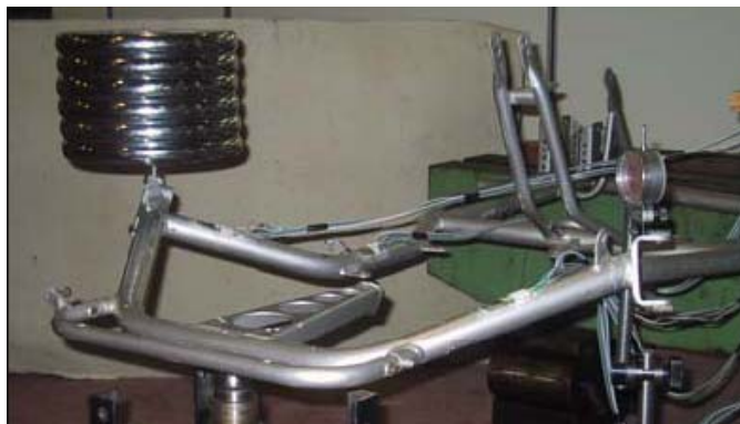
Fig 5.30 - Analisi strutturale: condizioni di carico.
