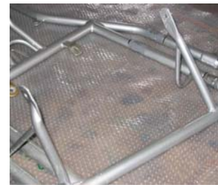
Fig 5.18 - Elementi di ancoraggio del sedile.
