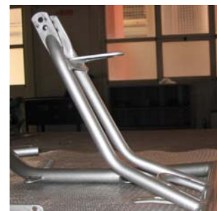
Fig 5.17 - Ancoraggio posteriore dello sterzo.
