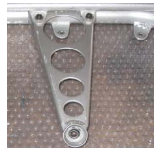
Fig 5.16 - Ancoraggio anteriore dello sterzo.
