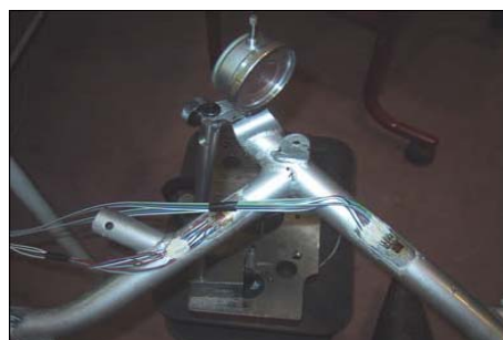
Fig 5.31 - Analisi strutturale: posizionamento degli strumenti di misura.
