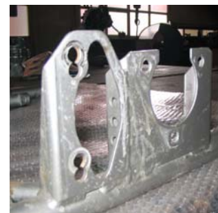
Fig 5.19 - Fissaggio assale posteriore.
