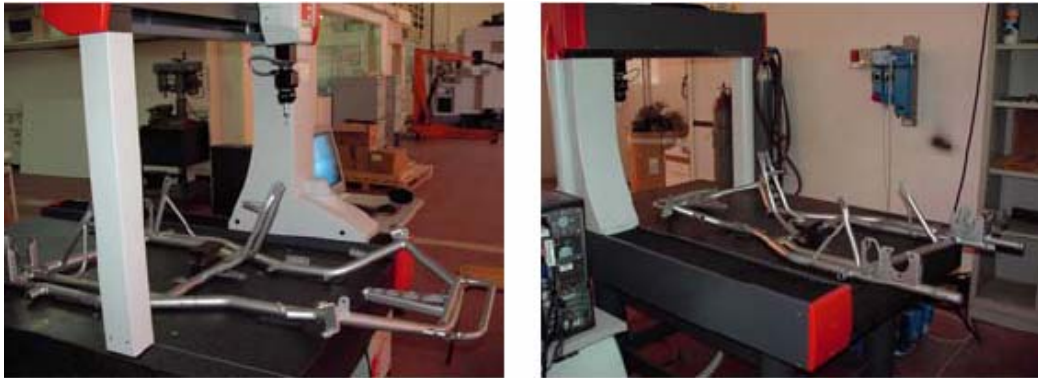
Fig 5.14 - Set di misura relativi ai processi d'acquisizione della parte posteriore ed anteriore del Telaio.
