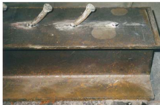
Figura 3.12 Aspetto dei connettori a piolo dopo la prova (Lam, 2006).
