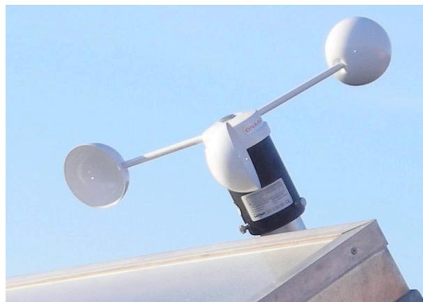
*Fig. 5.5 – Anemometro a coppelle per la misura della velocità del vento sul piano dei collettori*
