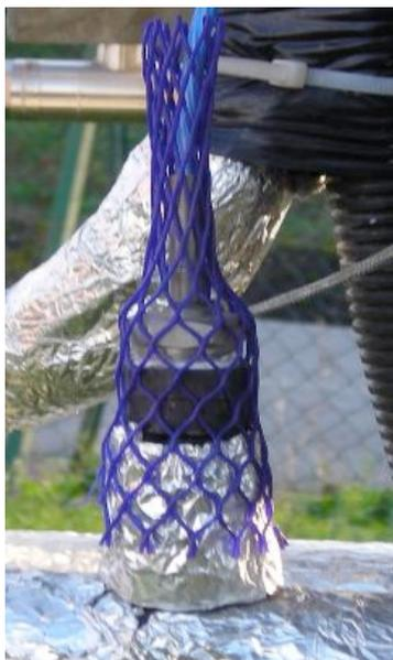
Fig. 5.6- Sonda di temperatura Pt 100
