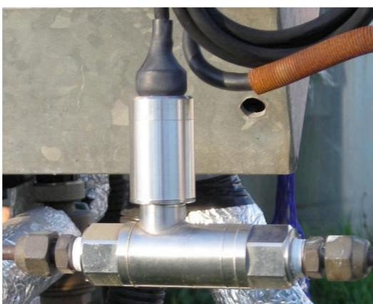
Fig. 5.7 – Pressostato differenziale
