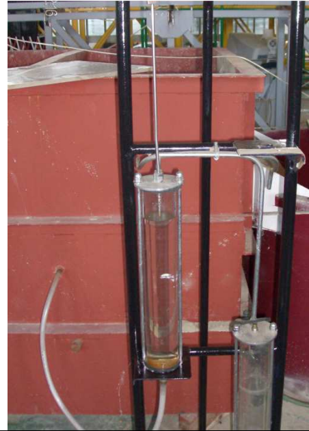
Figura 3.7. Sezione longitudinale del cassone con stramazzo Thomson e particolare della presa piezometrica.
