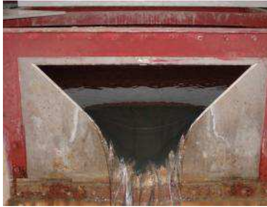
Figura 3.6c. Vena effluente dallo stramazzo Thomson.
