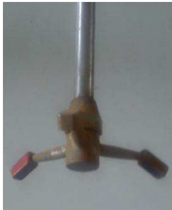
Figura 3.13. Trasmettitori e ricevitori acustici dell'ADV Vectrino (sonda down-looking ).
