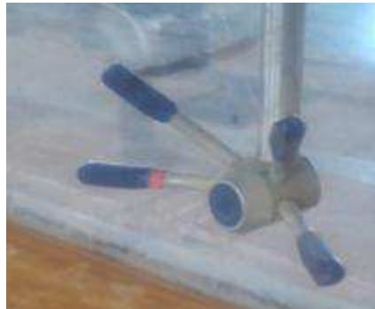
Figura 3.12. Trasmettitori e ricevitori acustici del Vectrino Velocimeter . Asta side-looking .
