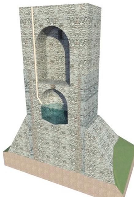
S. Niceto. Visuale della torre mastio e ricostruzione del sistema di raccolta delle acque nella cisterna.
