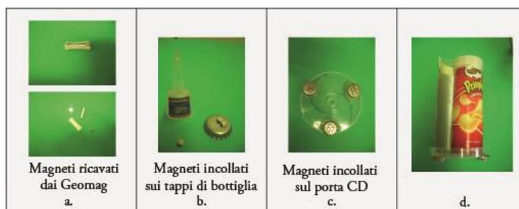
**Fig. 4:** Tagliando i Geomags è possibile ricavare dei piccoli magneti (a), i quali vengono incollati ad un tappo di bottiglia per ottenere un magnete più grande (b). I magneti ottenuti sono fissati alla base delle pale eoliche (d) attraverso un coperchio di porta CD (c), in modo da poter ruotare assieme ad esse sotto l'azione del vento.
