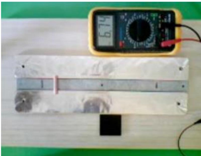
**Fig. 22:** L'immagine, presa da un frame tipico catturato attraverso la webcam mentre riprende il moto del cilindro sulle guide, mostra alcuni dettagli dell'apparato sperimentale. Si distinguono il cilindro di rame, le guide conduttrici di rame ricoperte di carta alluminio (il quale garantisce un maggiore contatto elettrico), un tester digitale, la barra magnetica al centro delle due guide.
