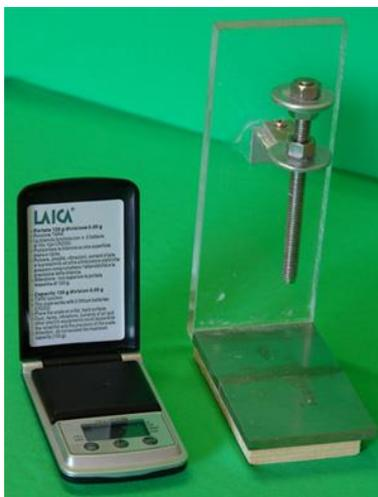
**Fig. 30:** Bilancia di precisione (a sinistra) e struttura in Plexiglass (a destra) su cui è fissato un supporto in alluminio attraverso cui può scorrere una vite in acciaio Inox.
