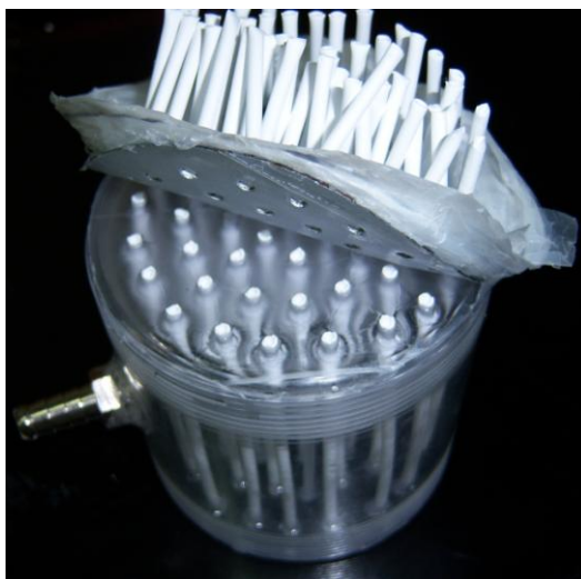
Figura 2.14 - Realizzazione modulo a fibre: rimozione materiale in eccesso.
