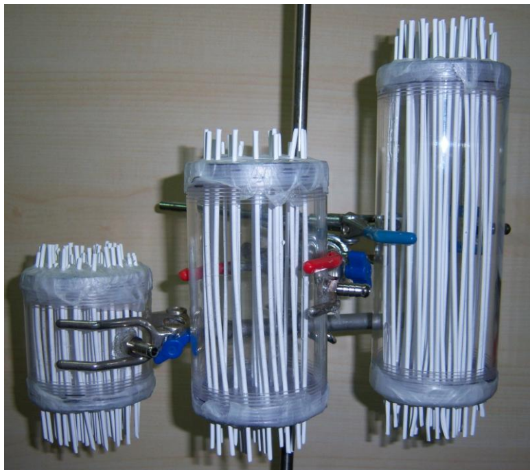
Figura 2.12 - Moduli a fibre usati nella configurazione in flusso in fase di realizzazione.
