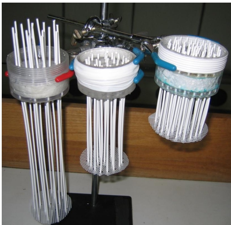
Figura 2.19 - Moduli a fibre immerse in fase di realizzazione.
