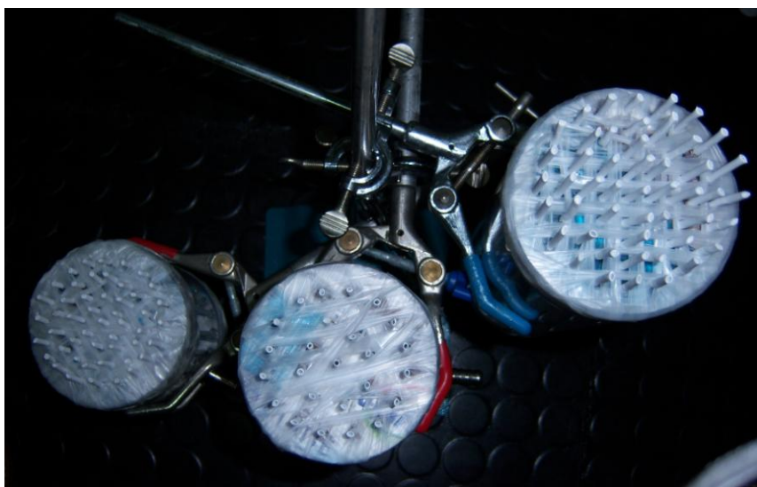
Figura 2.13 - Moduli a fibre usati nella configurazione in flusso in fase di realizzazione (sezione trasversale).
