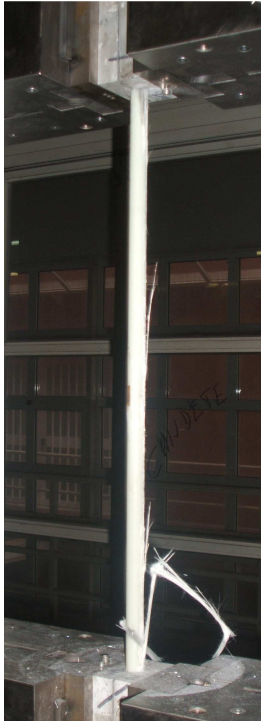
Figura 4.2: Modalità di rottura di una barra di GFRP in una prova di trazione
