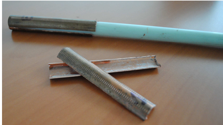
Figura 3.4: Afferraggio delle barre di FRP in tubolari di rame
