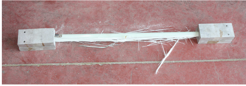
Figura 4.13 b: Modalità di rottura delle barre in prove di creep, carico al 70%.
