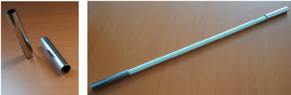
Figura 3.3: Afferraggio delle barre di FRP in tubolari di acciaio
