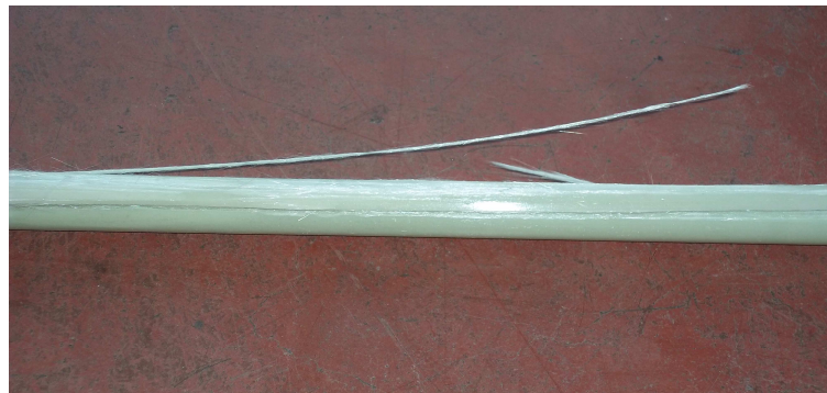
Figura 4.17: Rottura della barra nella prova di creep 13 aprile 2011
