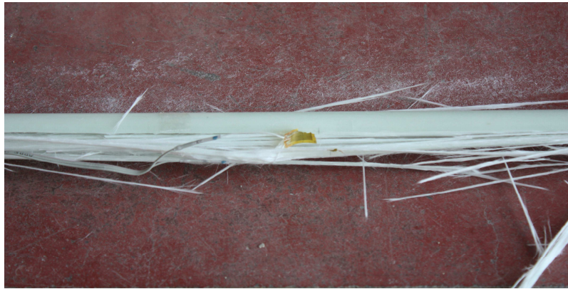
Figura 4.14 Particolare della rottura, con scollamento e rottura dell'estensimetro
