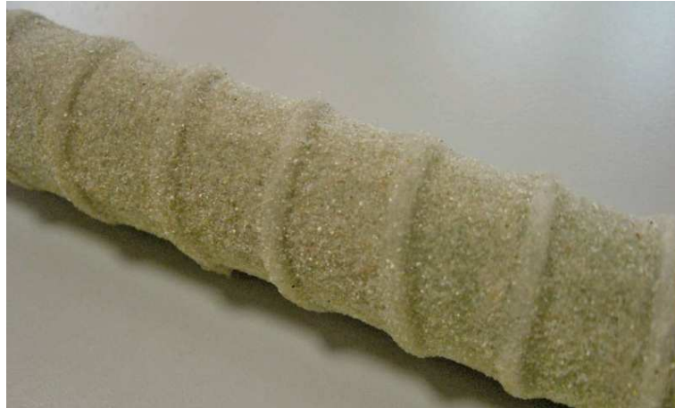
Figura 5.10: Barra in GFRP con superficie scabra
