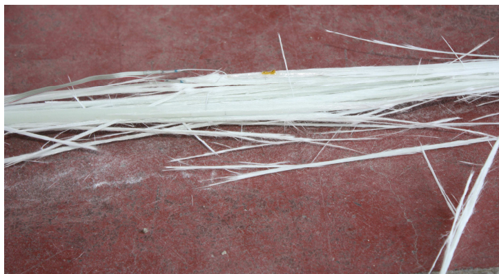
Figura 4.13 a: Modalità di rottura delle barre in prove di creep, carico al 70%.
