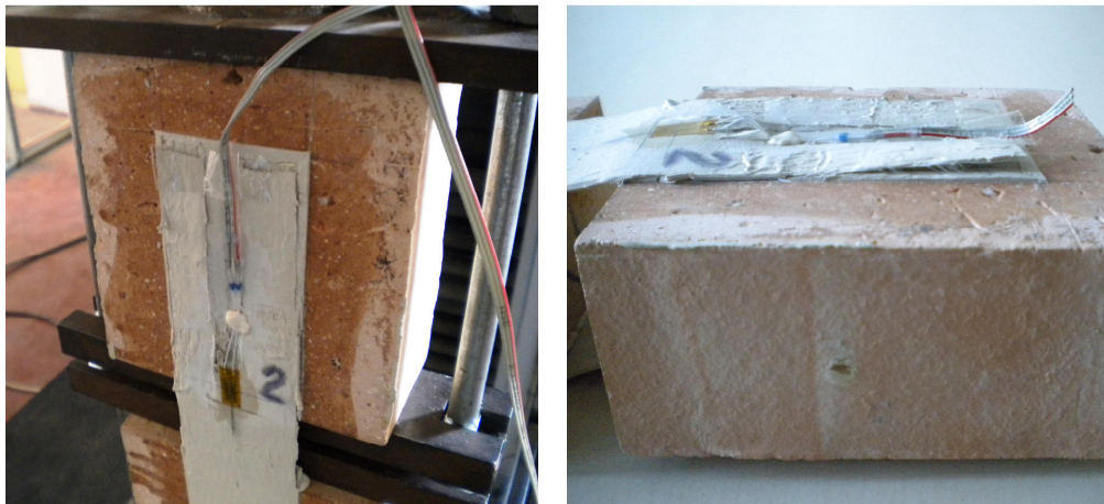
Figura 3.38 Delaminazione dei provini con G-FRCM
