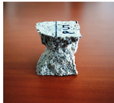
Figura 3.9 Rottura per compressione dei cubetti di malta
