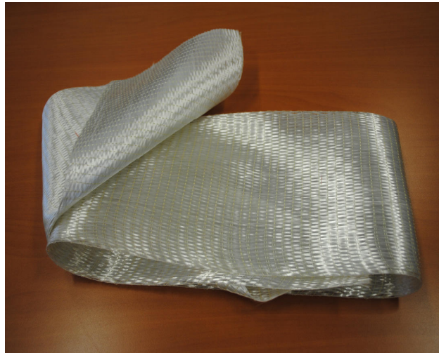
Figura 3.17 Tessuto unidirezionale in fibre di vetro
