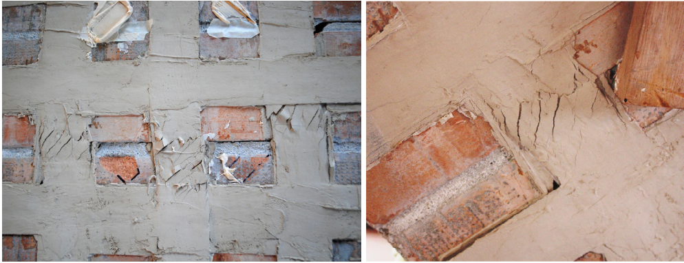
Figura 4.22 Comportamento del rinforzo a flessione nel piano
