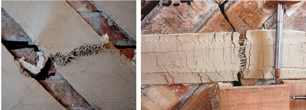
Figura 4.26 Crisi per trazione delle fibre di lino
