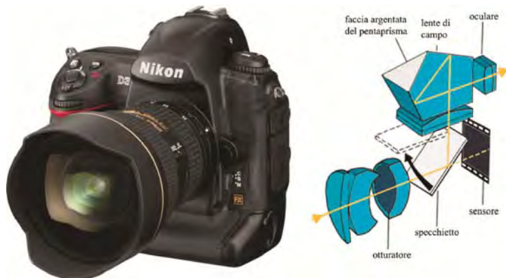
Fig. 3.4 – Macchina reflex e relativo schema ottico di funzionamento.
