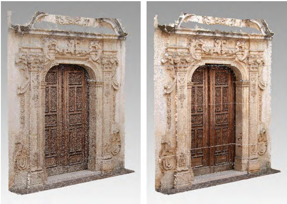
Fig. 5.15 – Portale della chiesa di S. Maria delle Vergini (Cosenza). Nuvola di punti, ottenuta da fotogrammi processati con il sistema web ARC3D ed elaborando i dati restituiti con MeshLab (1.5 milioni di punti); il modello poligonale elaborato dalla nuvola di punti, è stato realizzato in Geomagic Studio 12 ed è composto da 2.5 milioni di triangoli.
