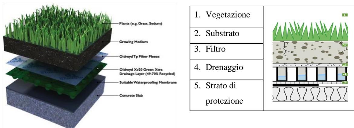
Fig. 1.10. Tipici strati di una copertura a verde.
