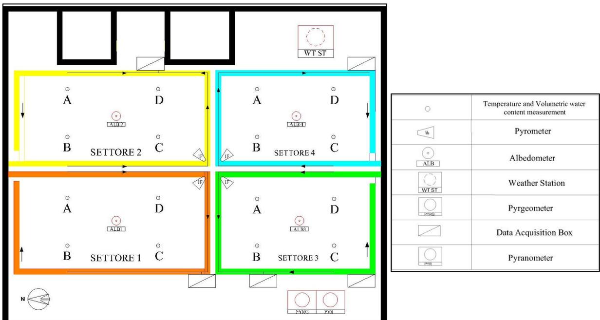
Fig. 2.18. Posizionamento sensori sulla copertura a verde
