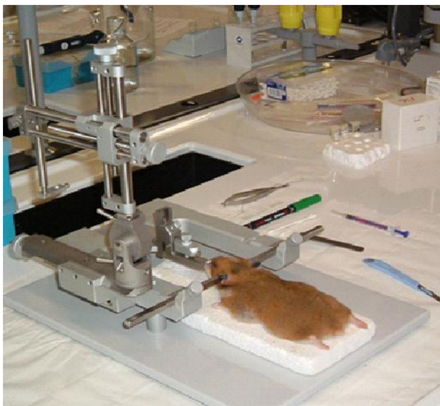
Fig. III.3 Strumento stereotassico adatto al trattamento di piccoli roditori.
