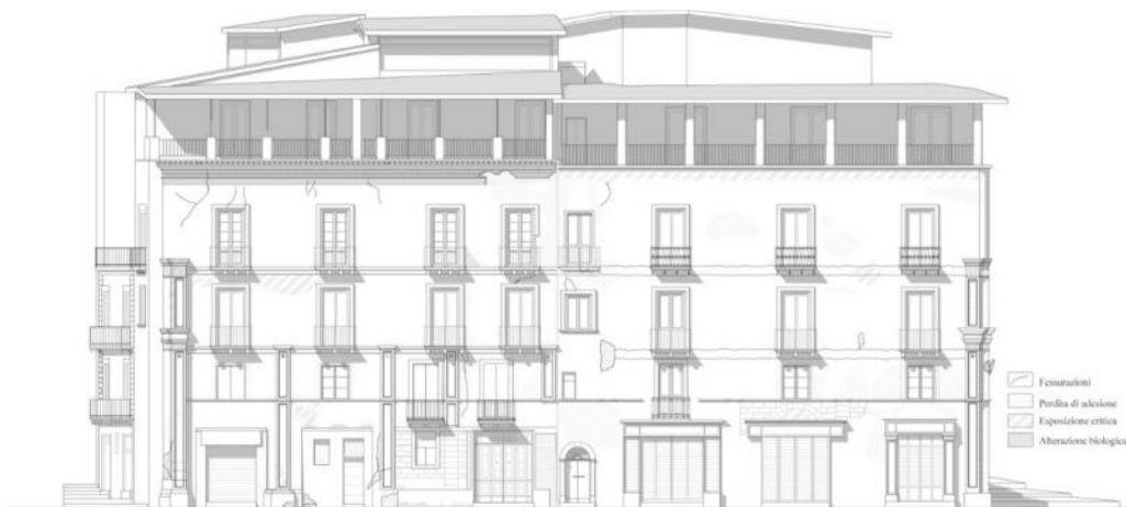
Figura 40 Stato di degrado del prospetto principale
