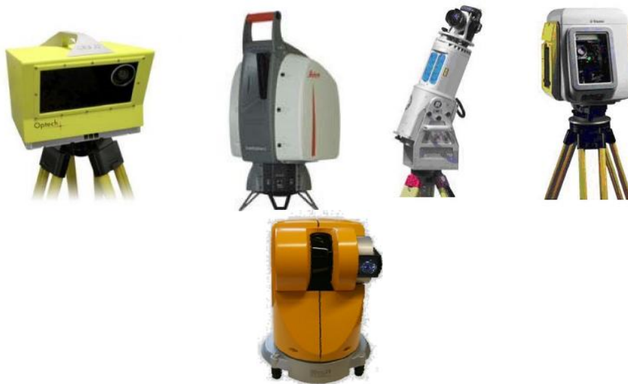
Figura 61 Alcuni scanner a tempo di volo commerciali: i produttori più noti sono Optech, Leica, Rieggl, Trimble, Callidus.
