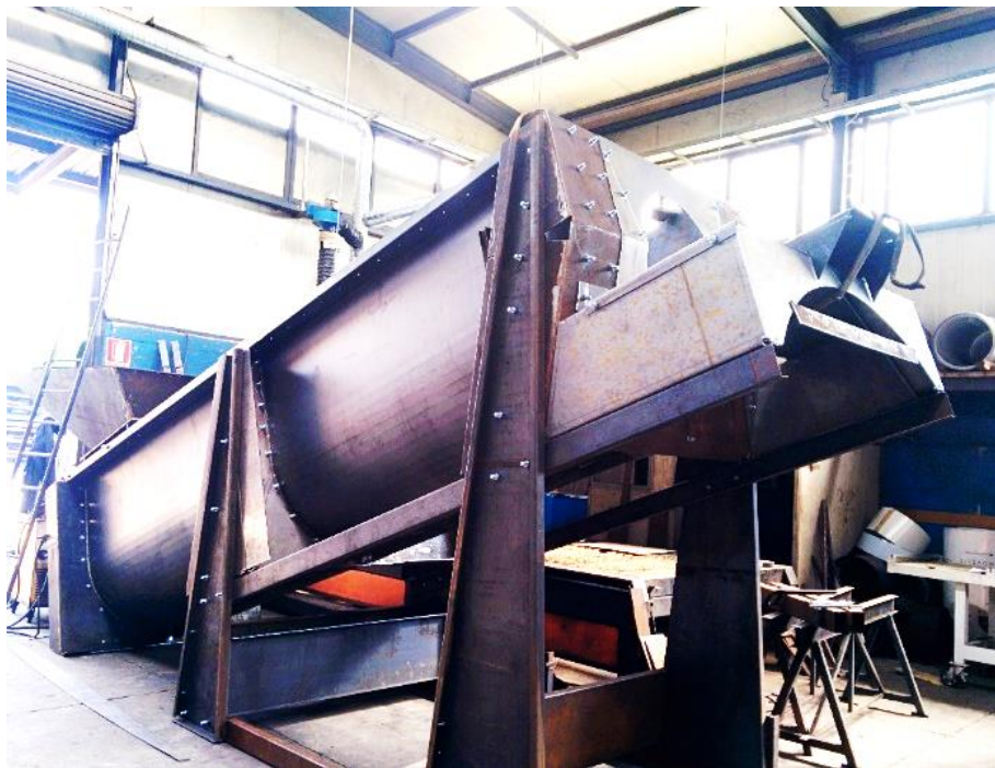
Figura 4.19. Parti meccaniche da carpenteria del prototipo di essiccatore a coclea
