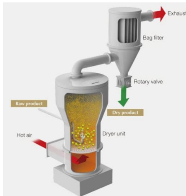
Figura 3.14. Schema di un essiccatore a letto fluido verticale.
