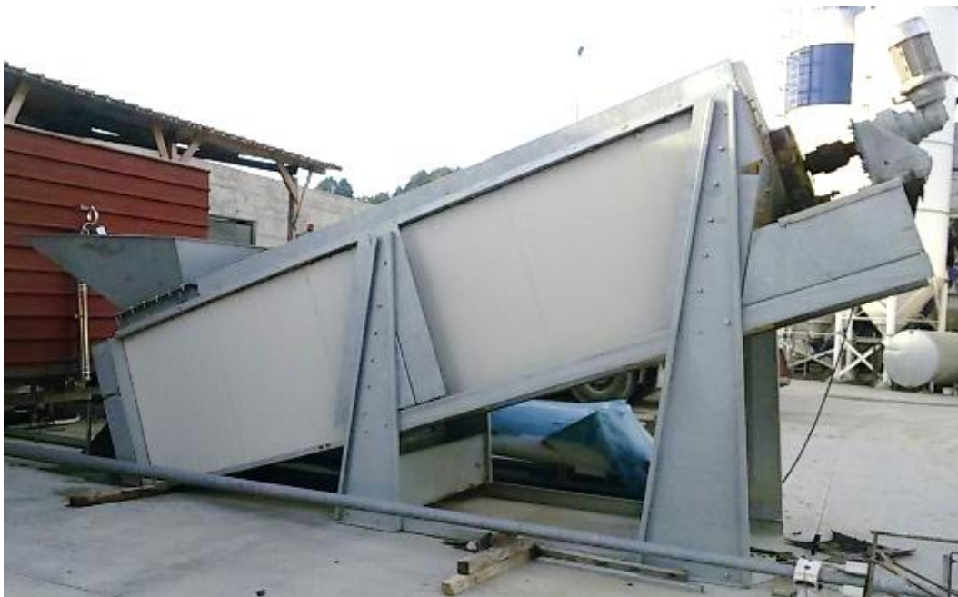
Figura 4.28. Prototipo di essiccatore a coclea de la Personal Factory.
