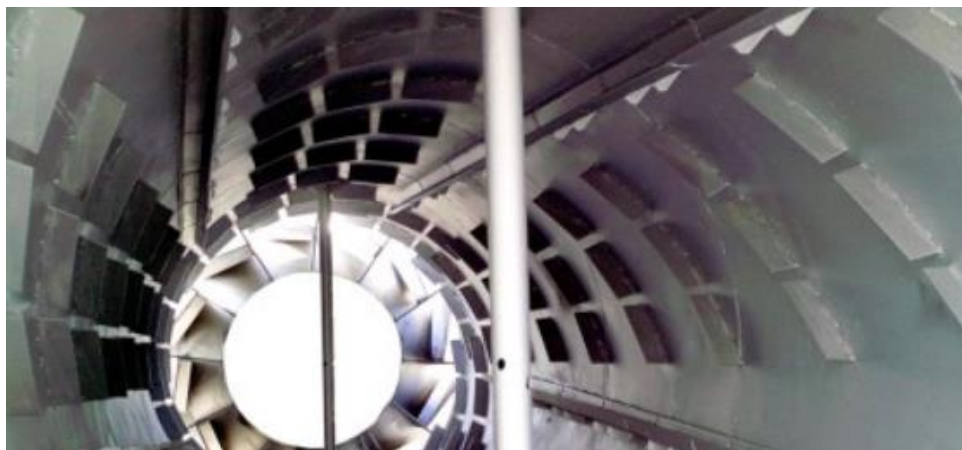
Figura 3.12. Esempio di tamburo rotante di un essiccatore rotativo.
