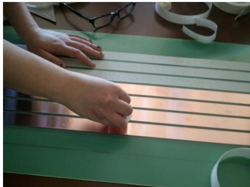
Fig.4. Posizionamento strips di rame
