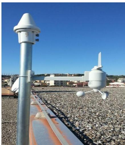
**Figura 3.30.** Antenna ricevitore GPS installata sul tetto dell'edificio scolastico
