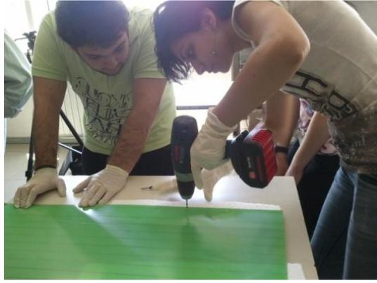
Fig. 2. Esecuzione fori sul piano di vetronite
