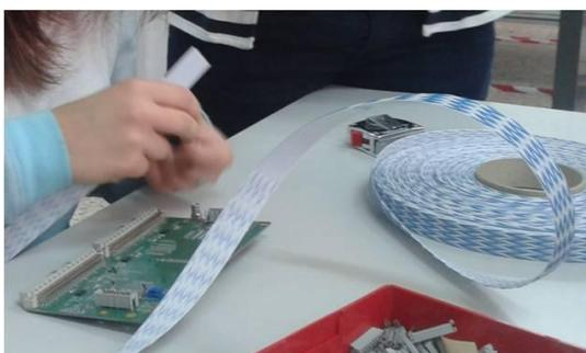
**Figura 3.17.** Allestimento scheda con connettore e cavi per prelevare i segnali.
