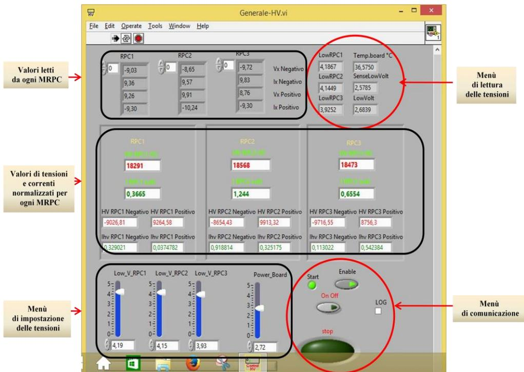
**Figura 3.13.** Pannello di controllo per il sistema LV-HV: in alto, a destra, è riportata la lettura delle basse tensioni impostate in basso a sinistra. Al centro sono riportati i valori delle alte tensioni e delle correnti riportate per ogni MRPC.
