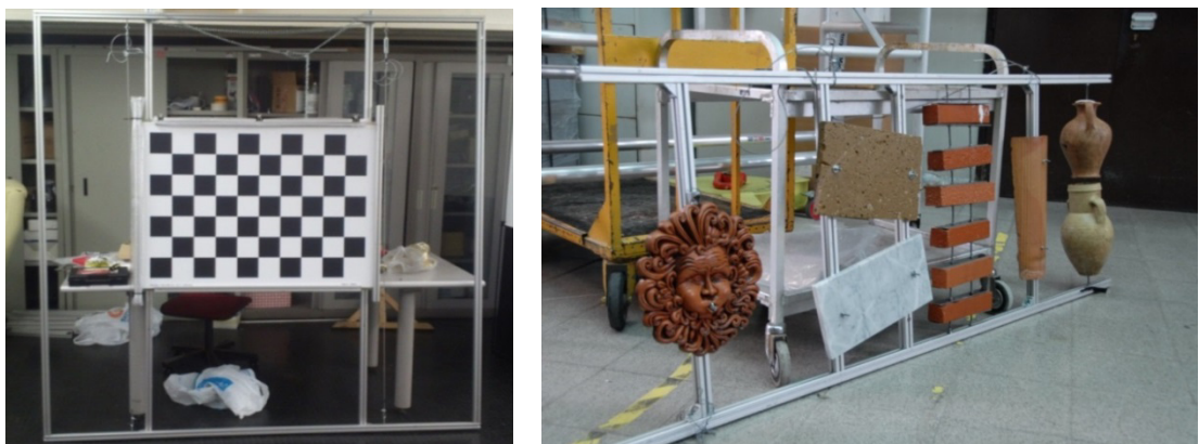
Fig. 2.19 Pannello di calibrazione (sinistra), target realizzato con oggetti di materiale e forma diversa (destra).
