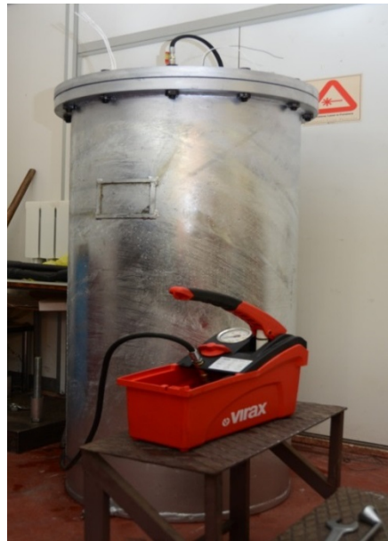
Fig. 2.4: camera idrostatica impiegata per le prove di tenuta degli scafandri.
