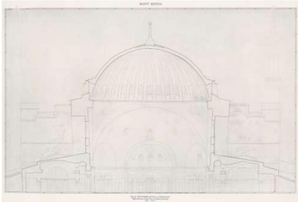
Fig. 1.8 Tavola n. 30 delle 46 realizzate da Van Nice, sezione trasversale vista da EST, Galleria Superiore e Cupola [Van Nice, 1965].
