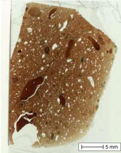
Scansione della sezione sottile del campione BAS4 a nicol paralleli.
