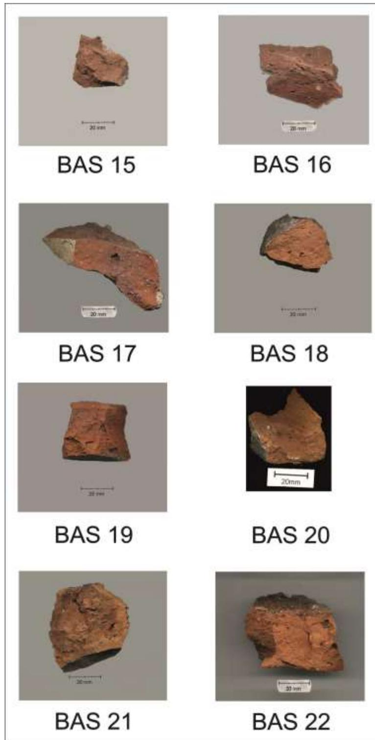
Fig. 2.2\_III. Immagini macroscopiche dei 29 campioni di laterizio prelevati da Hagia Sophia ottenuti mediante acquisizione con scanner piano in luce riflessa.
