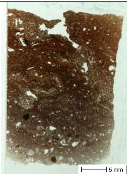
Scansione della sezione sottile del campione
