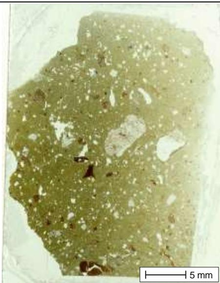
Scansione della sezione sottile del campione BAS7 a nicol paralleli.
