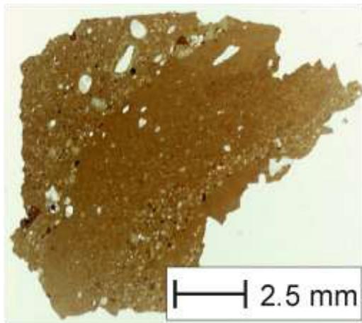
Scansione della sezione sottile del campione BAS1 a nicol paralleli.
