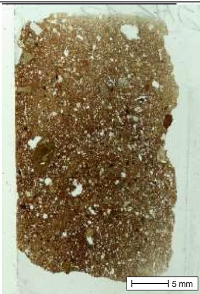
Scansione della sezione sottile del campione BAS13 a nicol paralleli.
