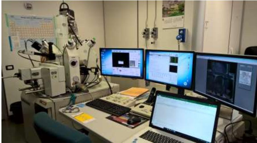
Fig. 2.19. Electron Probe Microanalyzer (EPMA) modello Jeol – Jxa 8230 utilizzato per l'analisi dei campioni.
