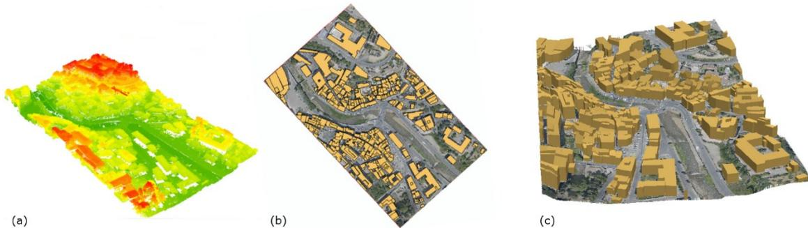
Figura 4-3.(a) Nuvola di punti proveniente da rilievo LiDAR; (b) ingombri planimetrici degli edifici; (c) estrusione degli edifici a tetto piano.
