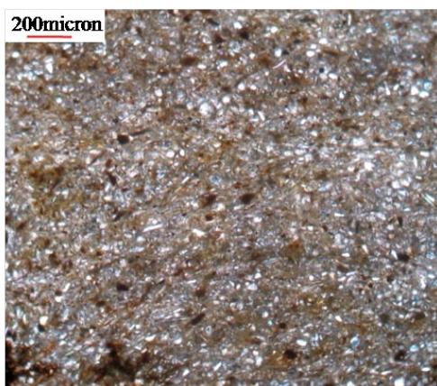
Figura 5.7: Immagini al microscopio ottico a nicols incrociati del campione FS. 7a) Vista a bassi ingrandimenti che evidenzia la tessitura della roccia. 7b) Dettaglio di un'area della sezione che evidenzia la matrice carbonatica localmente arrossata.
