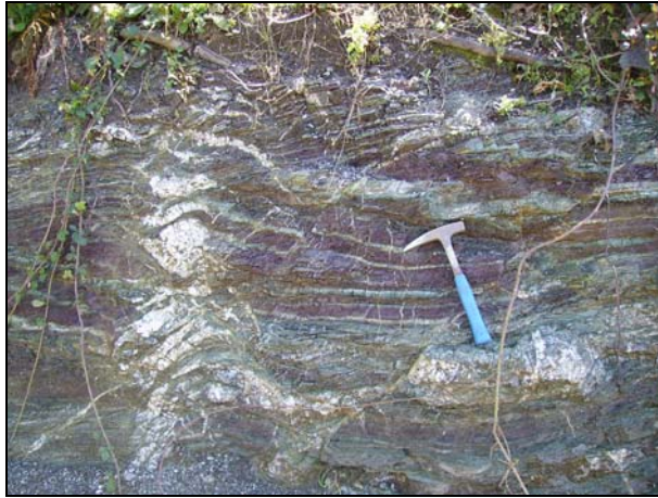
Figura 1.13 – Alternanze di radiolariti e semiscisti quarzosi verdognoli (copertura metasedimentaria delle ofioloiti); tali materiali appaiono intensamente piegati e fratturati.
