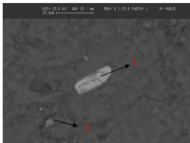
Figura 7.15 – Micrografia SEM del campione SM1: zirconio (1) e illite (2)
