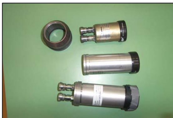
Figura 3.20 - Celle di Lucas: a) modello 110A per misure esterne; b) modello 300A per misure indoor (Continuos Passive Radon Detector); c) cella di pulizia; d) adattatore ABA
