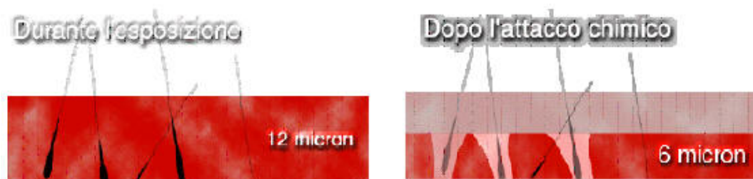
Figura 3.9 – Ingrandimento delle tracce dopo l'attacco chimico
