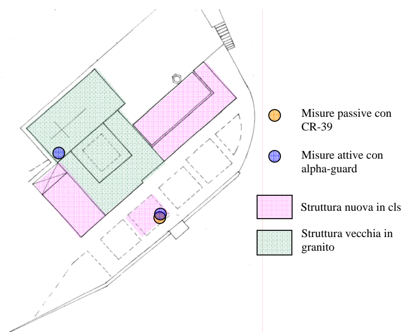
Figura 6.27 – Stralcio planimetrico catastale del Convento dei Padri Cappuccini, con localizzazione dei punti di misura
