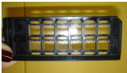
Figura 3.7 – Rivelatori CR-39 nelle apposite slide
