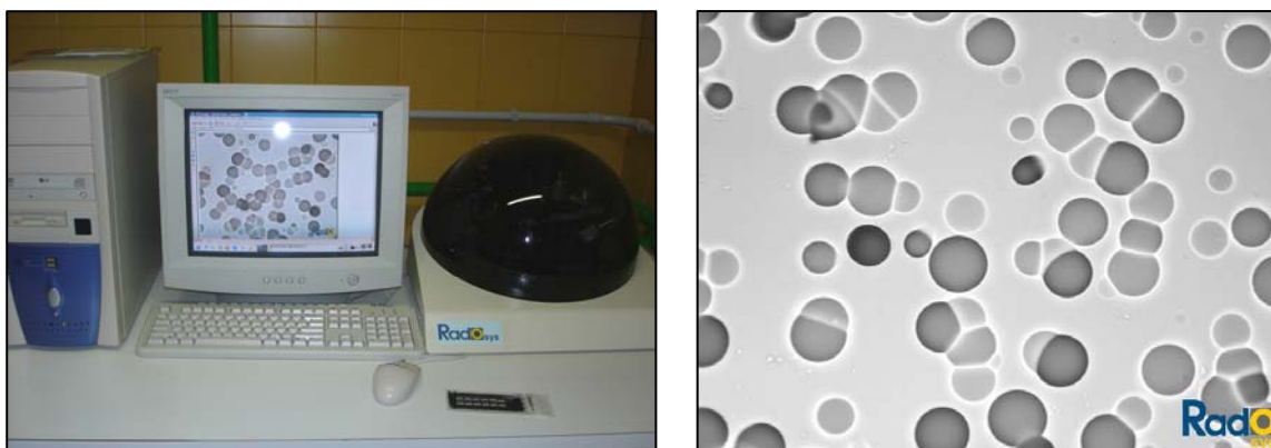
Figura 3.18 – Microscopio ottico a lettura automatica, e foto di particelle \alpha rilasciate dal Radon
