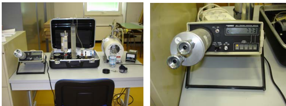
Figura 3.19- Apparecchiatura Pylon con sistema di degasaggio WG-1001 e con celle di Lucas
