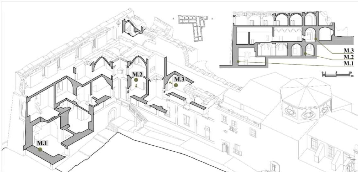
Fig. 3.5: Elaborati grafici dell'ex collegio con indicazione dei setti murari testati: spaccato assonometrico (a); sezione (b).
