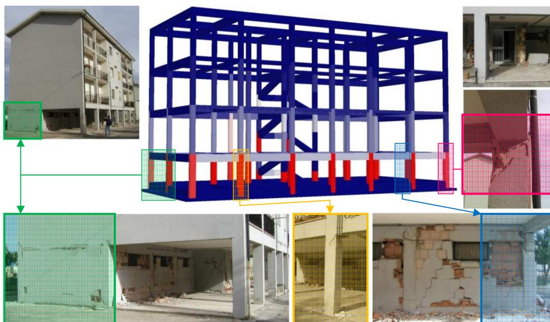
Figura 8-28. Confronto fra danneggiamento reale e risultati dell'analisi pushover – Prospetto Sud.
