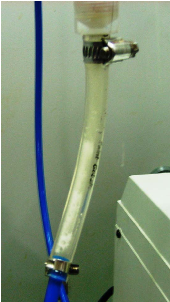
Figura 6.9: Immagine fotografica della soluzione uscente dal contattore a membrane con le fibre in polipropilene durante le prove di solubilizzazione del metano ( P_{\text{met}} = 4 \text{ bar} ; T = 25^\circ\text{C} ).
