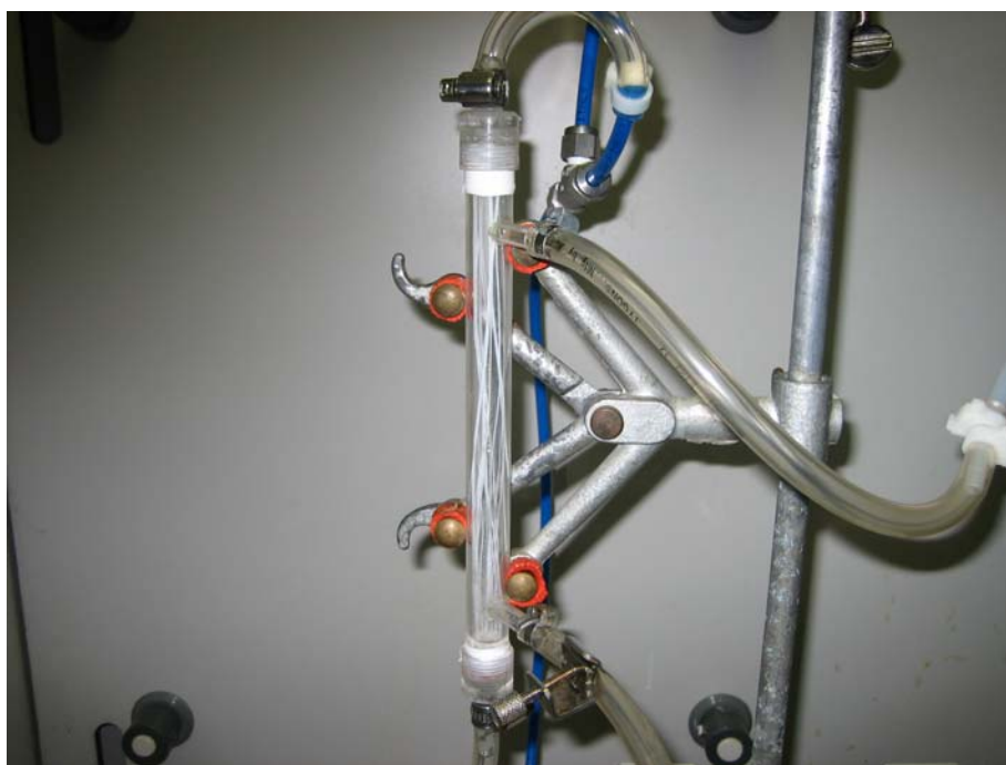
Figura 3.5: Contattore a membrana con modulo in policarbonato al cui interno sono state fissate 18 fibre in polipropilene del diametro esterno di 0.46 mm.
