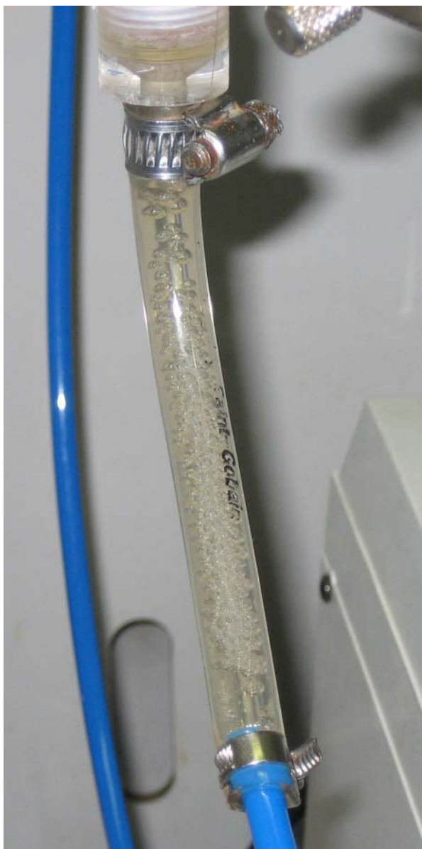
Figura 6.13: Immagine fotografica della soluzione uscente dal contattore a membrane con le fibre in polipropilene durante le prove di solubilizzazione del metano ( P_{\text{met}} = 4 bar; T = 25^{\circ}\text{C} ).
