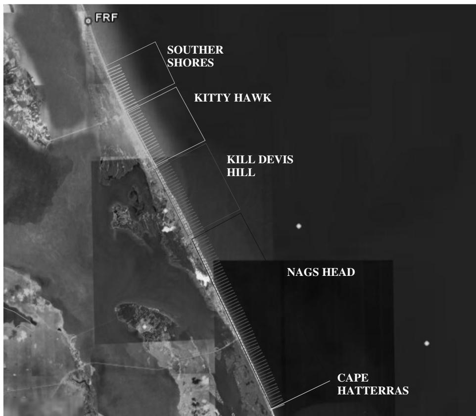
**Figura 5.24.** Posizionamento dei profili LIDAR lungo il litorale Outer Banks (Immagine da Google Earth)
