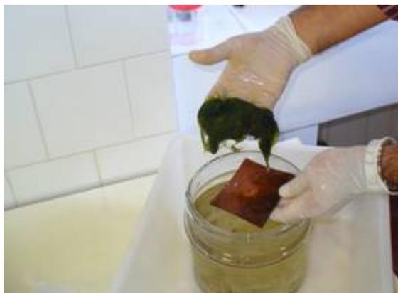
Fig. 36. Piastrelle con alghe filamentose prima della prove
