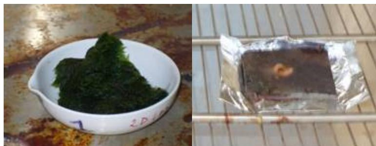
Fig. 37. Piastrelle alghe filamentose messe in stufa, per il calcolo del peso secco
