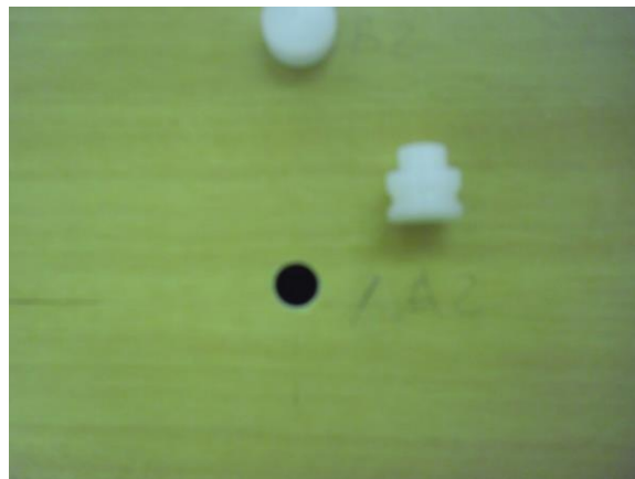
Figura 4. 53 - Sistema di raffreddamento: foro e tappo
