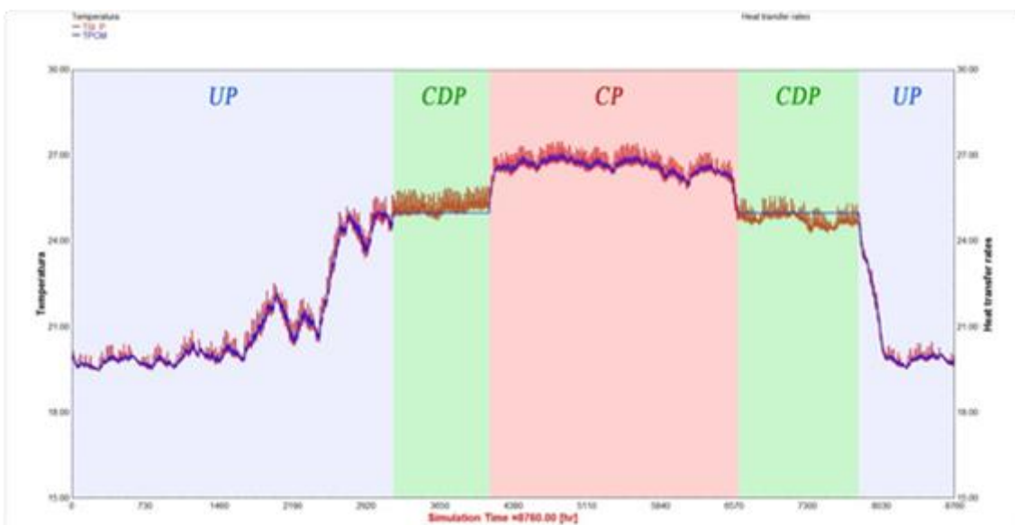
Figura 3. 34 - simulazione annuale della temperatura superficiale del PCM (linea blu) e del solaio (linea rossa)
