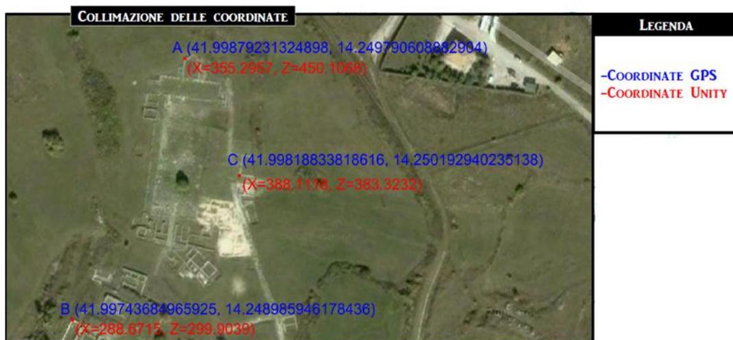
Figura 56. Associazione delle coordinate GPS al modello tridimensionale realizzato
